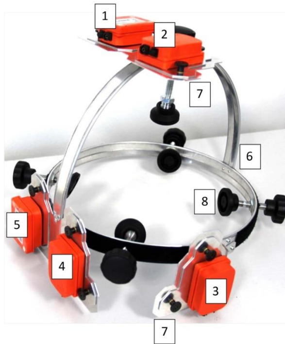
Obrázek č. 13 : Realizace helmice pro měření pohybu vestibulárních aparátů kde: 1 - posuvná deska parietální levá s upevněným gyro-akcelerometrem parietálním levým; 2 - posuvná deska parietální pravá s upevněným gyro-akcelerometrem parietálním pravým; 3 - posuvná deska temporální s upevněným gyro-akcelerometrem temporálním; 4 - posuvná deska okcipitální levá s upevněným gyro-akcelerometrem okcipitálním levým; 5 - posuvná deska okcipitální pravá s upevněným gyro-akcelerometrem okcipitálním pravým; 6 – vlastní konstrukce helmice; 7 - aretační šrouby; 8 – upínací šroub
