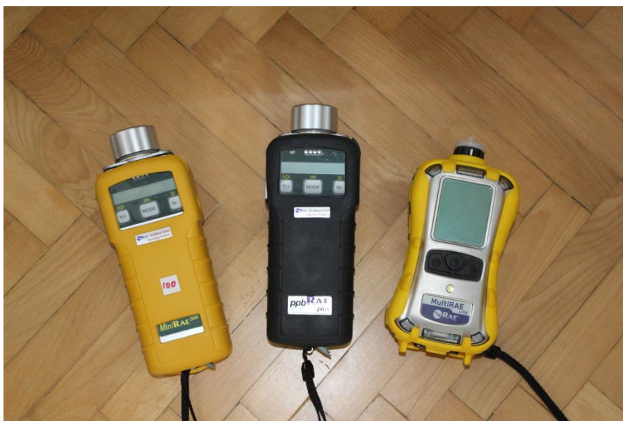
Obrázek 1 Fotoionizační detektory použité při experimentu, zleva: MiniRAE 2000, ppbRAE, MultiRAE lite
