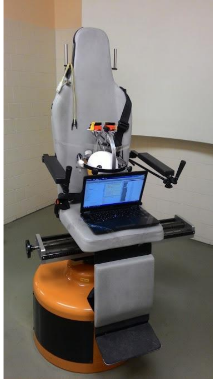
Obrázek 13: Měření fantomu na Bárányho křesle
