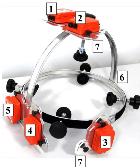
Obrázek 7: Gyro-akcelerometrická helma se senzory Xsens, převzato z [46]
