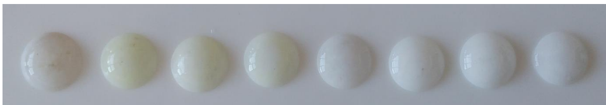
Obrázek č. 25: Obarvené mínusové čočky s nízkou optickou mohutností, do bílé barvy v závislosti na zvyšování časů (od 2 minut do 16 minut)
