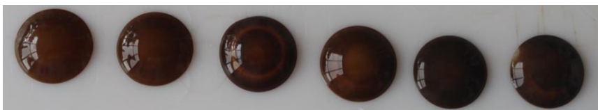
Obrázek č. 18: Obarvené plusové čočky s vysokou optickou mohutností, do odstínů hnědé barvy v závislosti na zvyšování časů (od 30 do 105 sekund).
