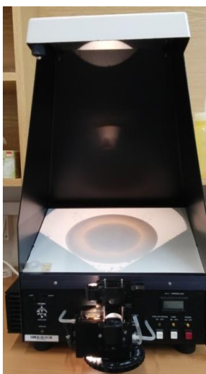
Obrázek č. 11: Analyzátor měkkých kontaktních čoček ukazující průměr barevné čočky
