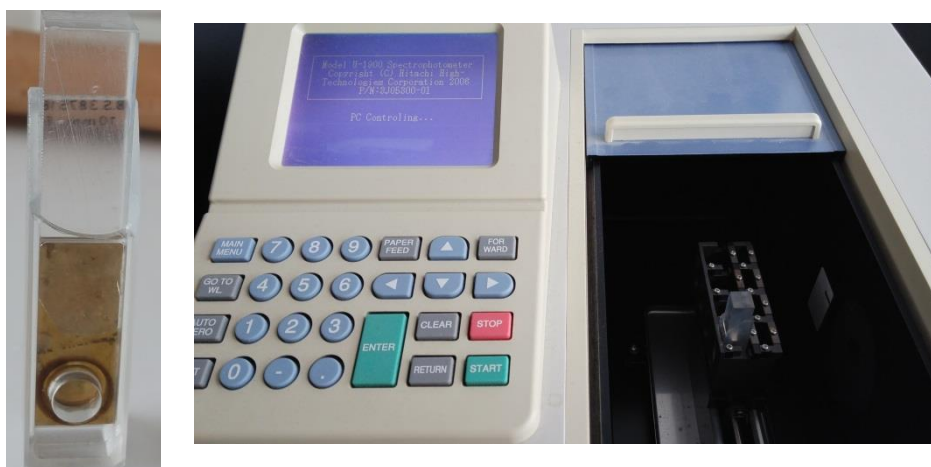
Obrázek č. 13: Vlevo kyveta s připraveným vzorkem, vpravo vzorek umístěný ve spektrofotometru
