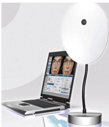
Obrázek č. 18: Centrovací videosystém: stolní zrcadlo s notebookem. [27]
