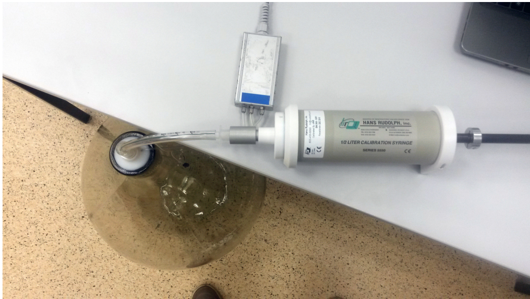
Obrázek 2.27: Aparatura ověřujícího experimentu, při kterém bylo prováděno simulované ventilování vzduchovou kalibrovanou stříkačkou. Jako model plic pro clonku s průsvitem 5 mm byla použita rigidní skleněná nádoba s objemem 15 l.
