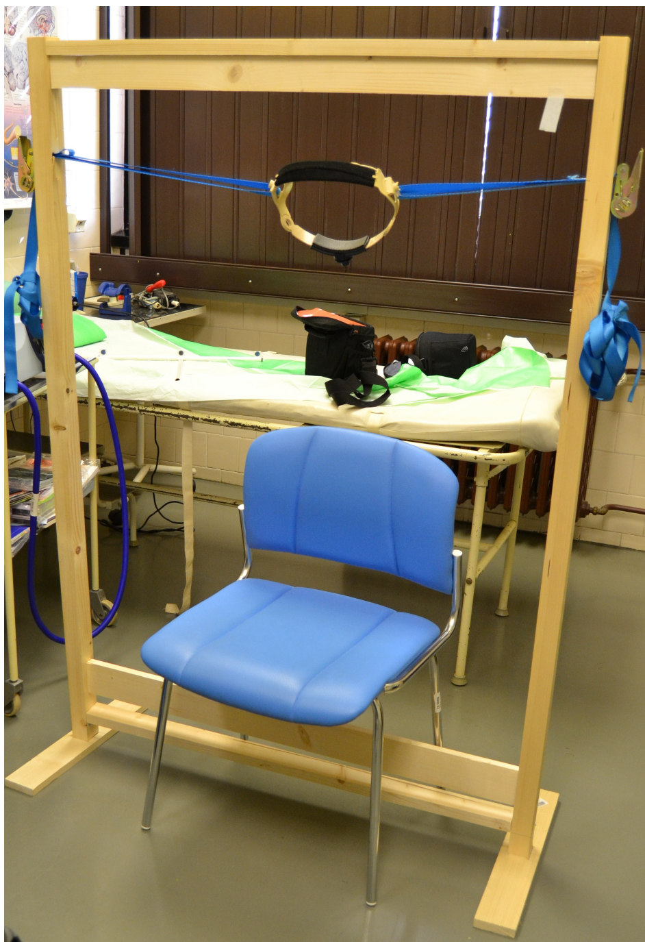
Obrázek 7.4: Fixační zařízení pro upevnění hlavy zkoumaného probanda.
