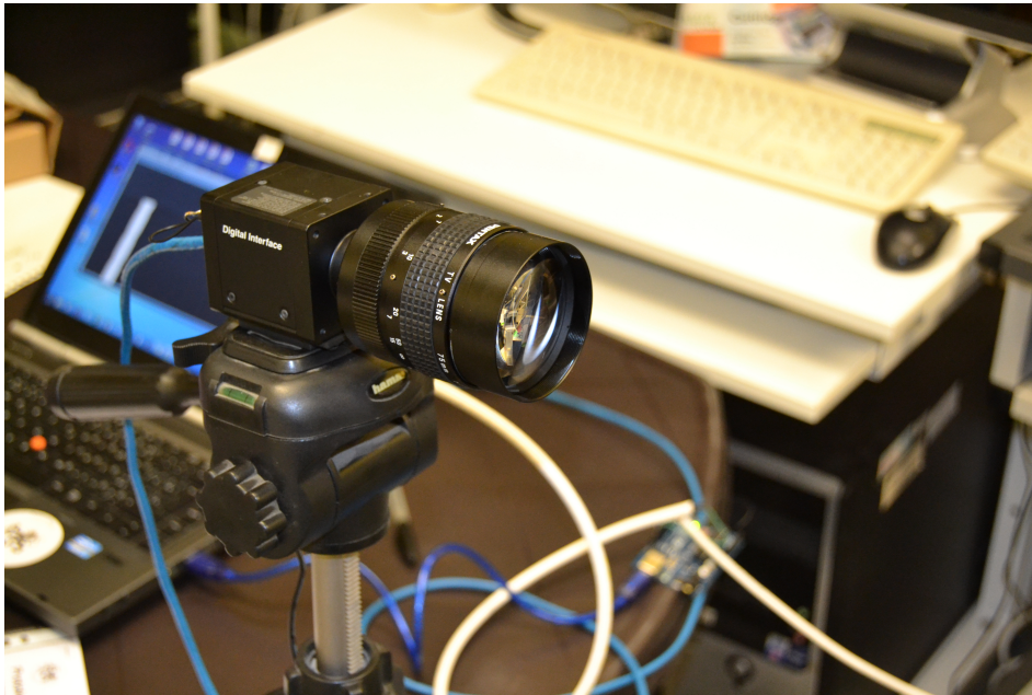
Obrázek 7.3: Snímací zařízení propojené s PC a mikropočítačem Arduino připravené k záznamu dat.
