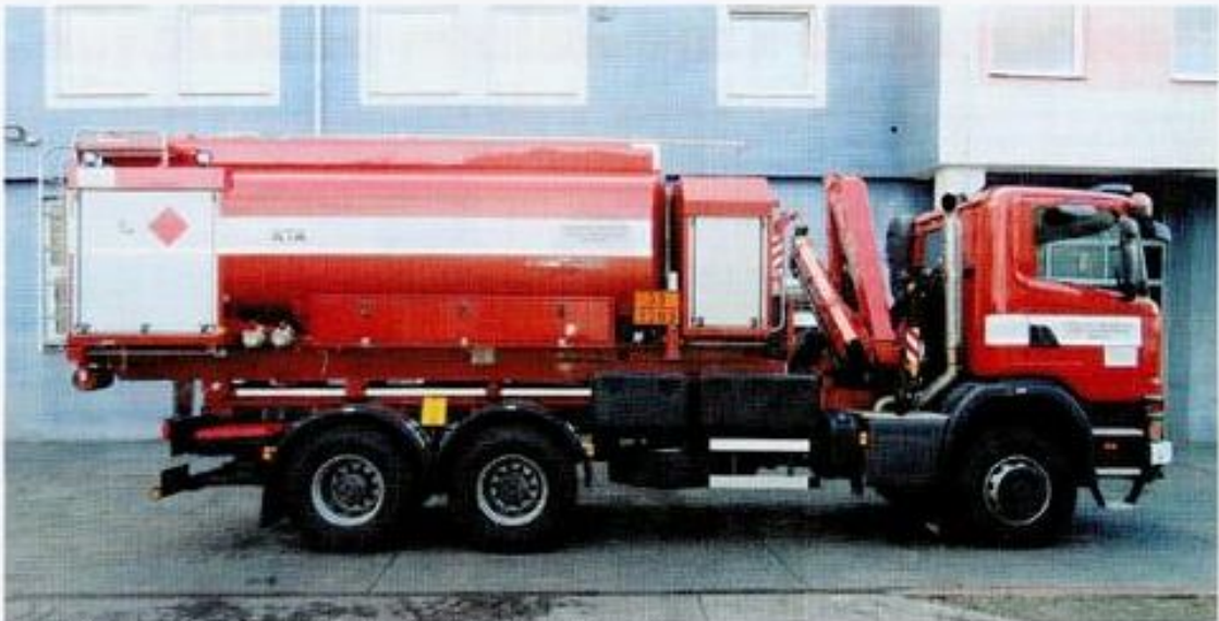
Obrázek 3 Tankovací kontejner – pro přepravu až 3000 l benzínu a 7000 l nafty
