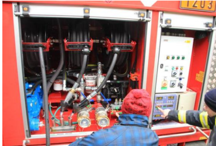
Obrázek 13 - Výdejní místa tankovacího kontejneru [foto vlastní]
