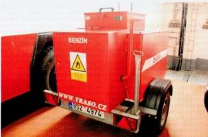
Obrázek 4 Tankovací přívěsný vozík pro přepravu až 850 l benzínu v nadlimitním množství
