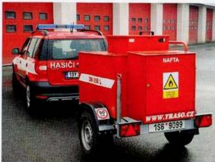
Obrázek 1 Tankovací přívěsný vozík pro přepravu až 850 l nafty v podlimitním množství
