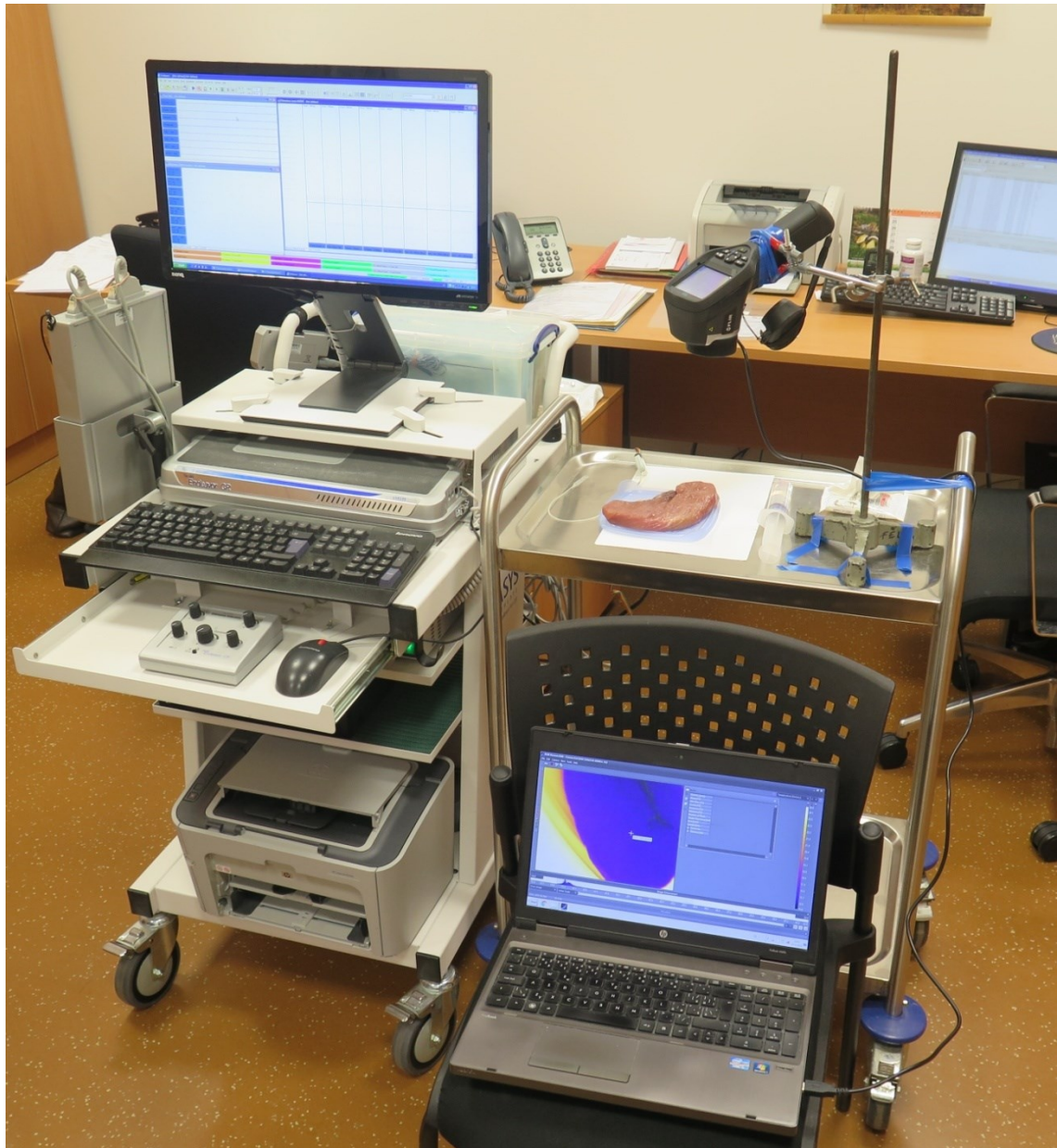
Obrázek G5: Sestavená aparatura pro měření tepelných účinků stimulace na fantomu biologické tkáně (vepřové maso)
