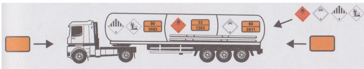
Obrázek 10 - Označení vícekomorové cisterny přepravující více druhů nebezpečných věcí [22]
