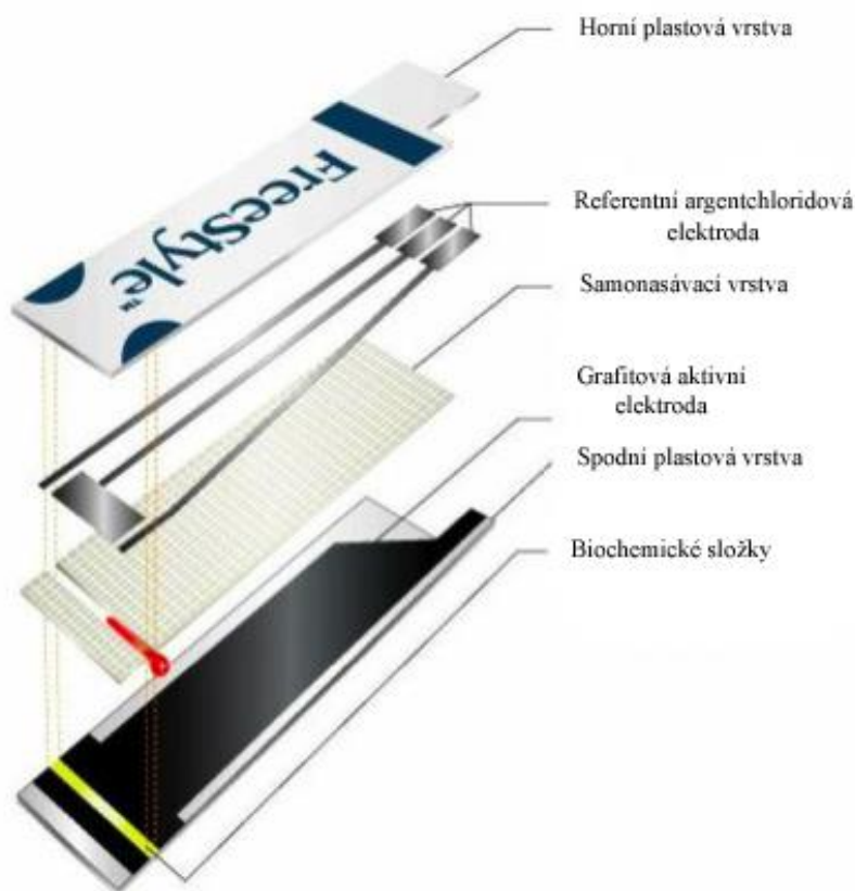
Obrázek 7 - Schéma testovacího proužku založeném na elektrochemickém principu (Electrochemical Glucometers, 2016, překlad popisu)
