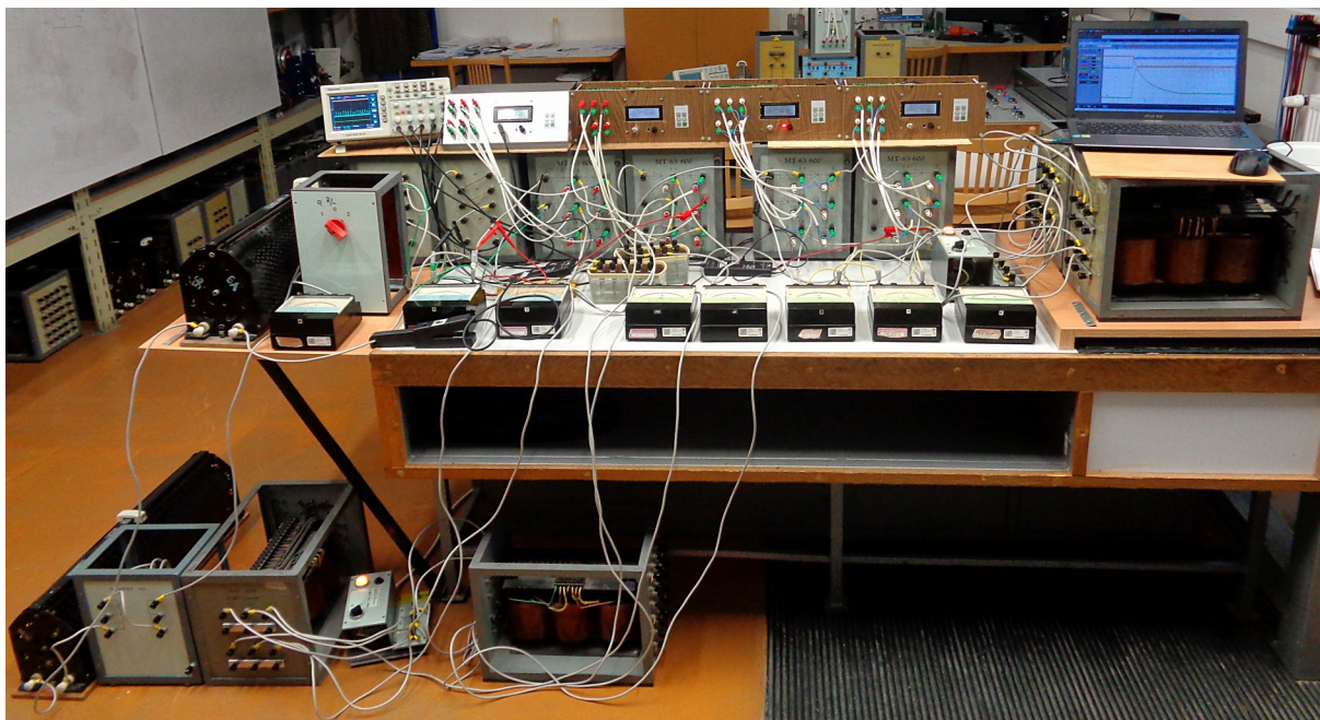
Obr. 78 Fotka pracoviště (měření na dvanáctipulzním reverzačním usměrňovači)
