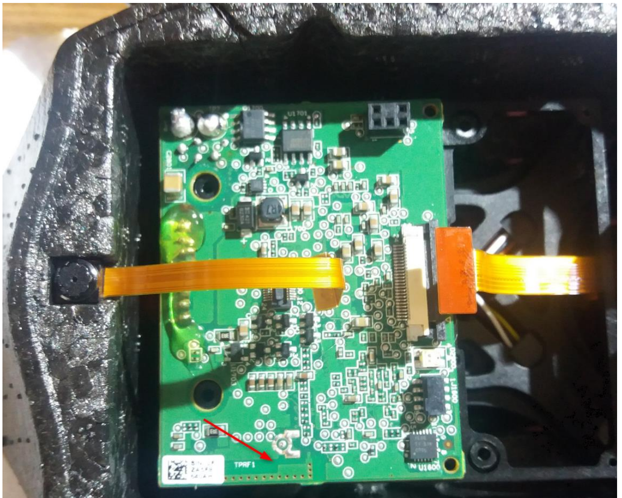
Obr. 26 - Umístění a tvar vnitřní antény
