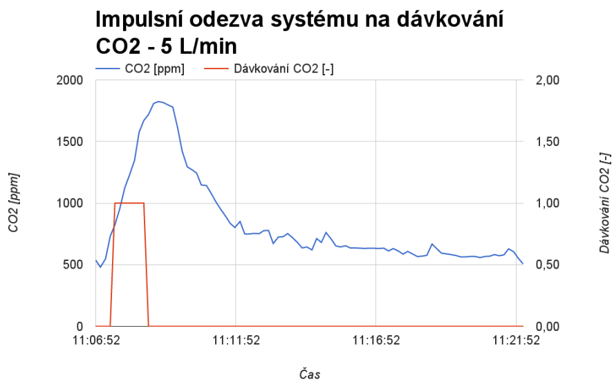
Obrázek 4.6: Impulsní odezva koncentrace oxidu uhličitého v pěstebním boxu na sepnutí ventilu při průtoku 5 l/min
