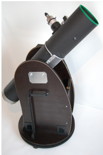
Obrázek : montáž zakrytovaná
