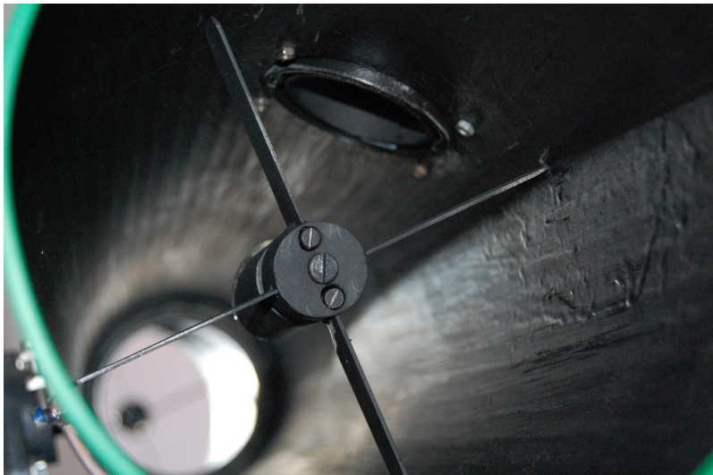
Obrázek : přichycení sek. zrcadla
