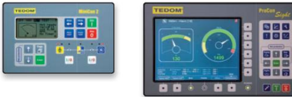
Obr. 14: Displej pro místní ovládání kogenerační jednotky [9]
