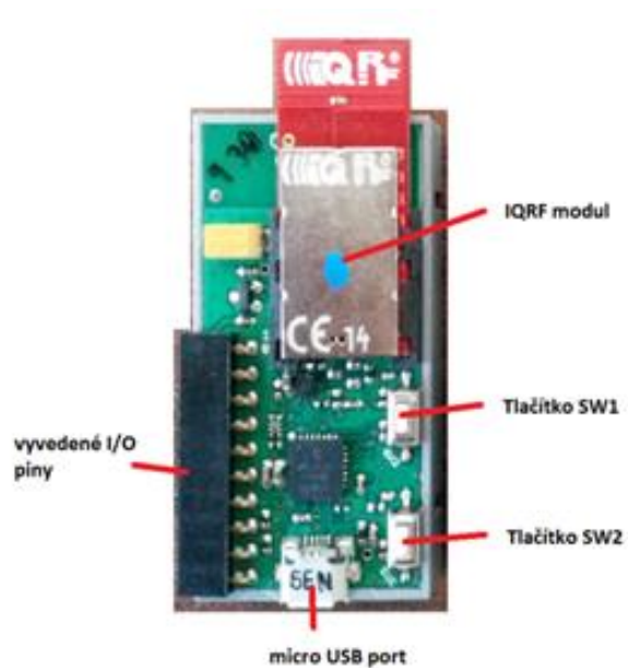
Obr. 10 IQRF programátor CK-USB-04A s vloženým komunikačním modulem
