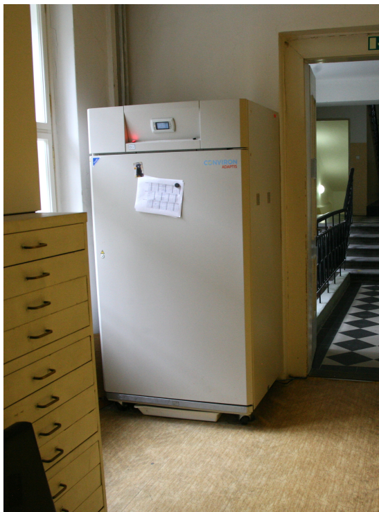
Obrázek 1 Růstová komora – udržuje předem stanovené teploty, množství světla a úroveň vlhkosti.
