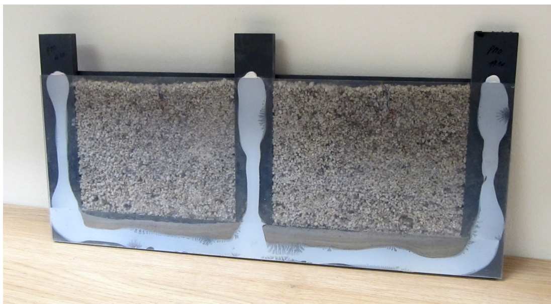
Obrázek 10 Typický dvoukomorový květináč s přední průhlednou stěnou. Květináč je naplněný perlitem, ve kterém roste rostlina.
