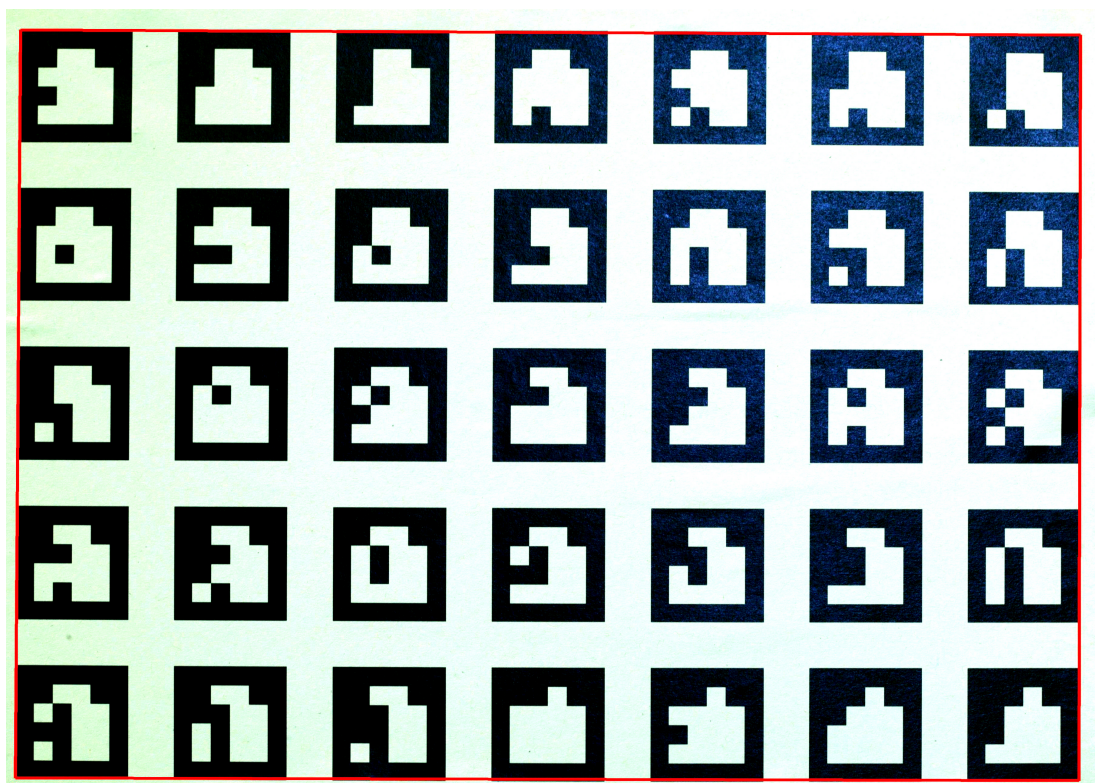
Obrázek 18 Kalibrační obrazec vyfotografovaný fotoaparátem, kterým byla snímána testovací data. Jedná se o Canon EOS-1 s makro objektivem s ohniskovou vzdáleností 100 mm. Do obrazu je přikreslen obdélník, jehož vrcholy odpovídají detekovaným rohům krajních značek. Radiální zkreslení objektivu nepřesahuje 5 pixelů.
