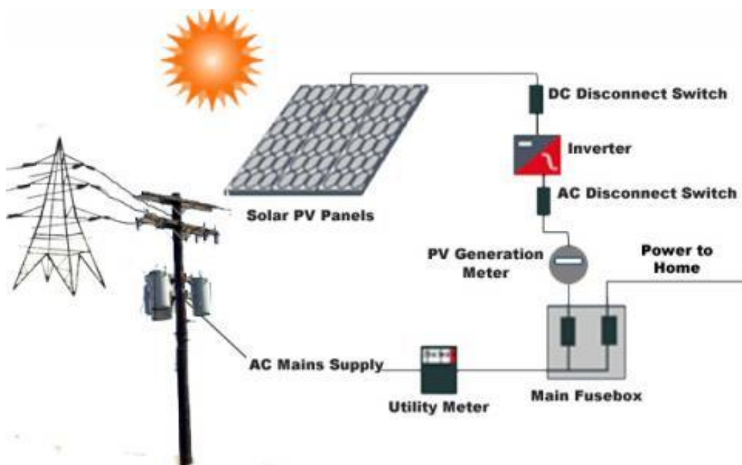
Obrázek 10 – Schéma fotovoltaické elektrárny, převzato z [16]
