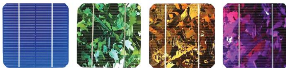
Obrázek 11 – Monokrystalický a barevné multikrystalické solární články, převzato z [15]
