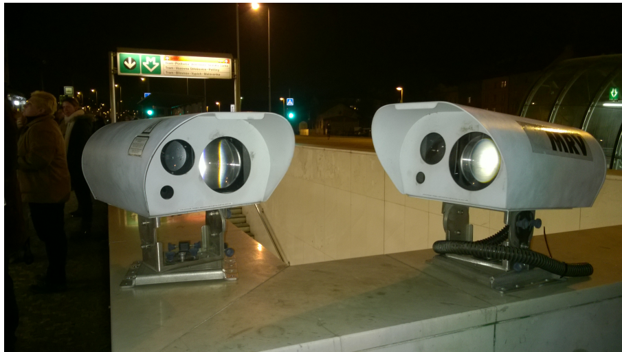
Obrázek 2.1: Zařízení pro přenos optického signálu volným prostorem
