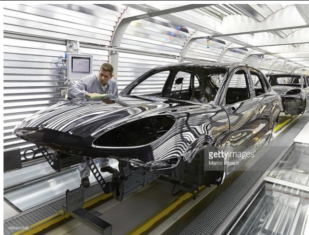
Obrázek 13 Výrobní kontrola povrchu karosérie [15]
