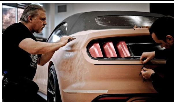
Obrázek 46 Práce sochaře na modelu karosérie v měřítku 1:1 [27]
