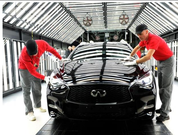
Obrázek 14 Výrobní kontrola povrchu karosérie [16]
