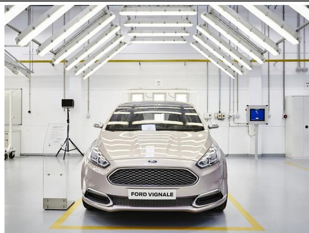
Obrázek 16 Výrobní kontrola povrchu karosérie [18]
