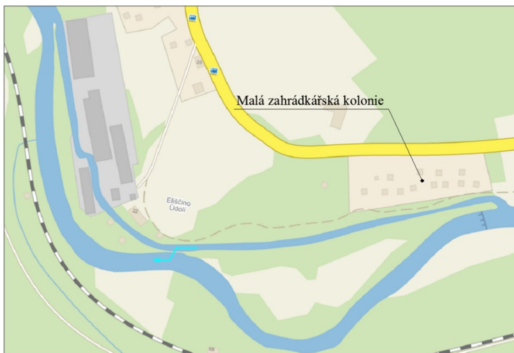
Obr. 4.4 - Znázornění přesměrování průtoku vody z derivačního přivaděče do řeky
