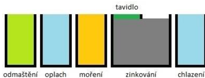
Obr. 2: Schéma sledu operací mokrého procesu žárového zinkování [2]
