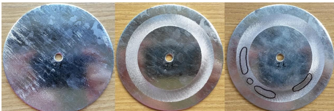
Obrázek 4: Lázeň s 0,068 hm. % Sn vzorek č. 1 (zleva) před testem, po 1600 cyklech, po 2800 cyklech s označenými místy bez zinkového povlaku
