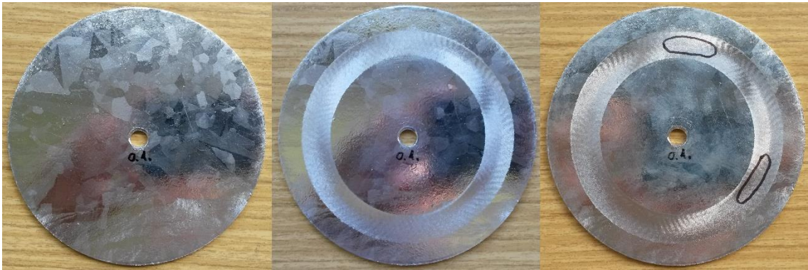
Obrázek 1: Lázeň s 0 hm. % Sn vzorek č. 1 (zleva) před testem, po 1600 cyklech, po 3000 cyklech s označenými místy bez zinkového povlaku
