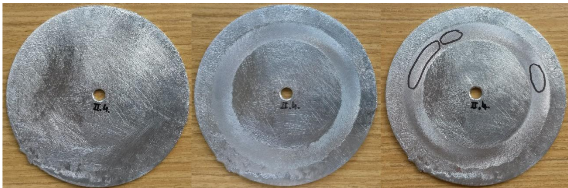
Obrázek 8: Lázeň s 0,499 hm. % Sn vzorek č. 4 (zleva) před testem, po 1600 cyklech, po 2600 cyklech s označenými místy bez zinkového povlaku
