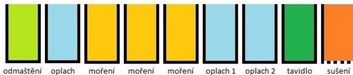
Obr. 3: Schéma sledu operací chemické předúpravy před žárovým zinkováním [2]
