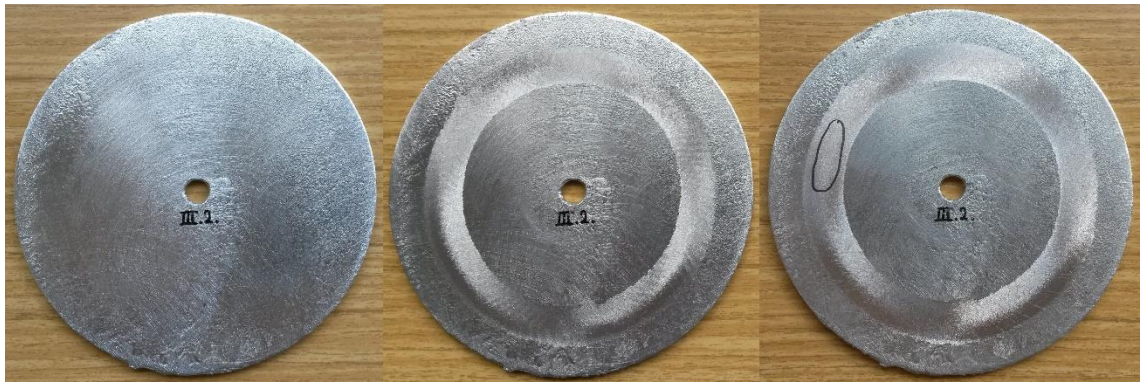
Obrázek 10: Lázeň s 1,12 hm. % Sn vzorek č. 2 (zleva) před testem, po 1600 cyklech, po 2400 cyklech s označenými místy bez zinkového povlaku
