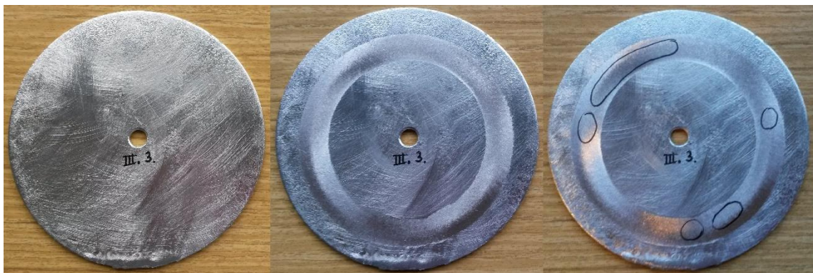
Obrázek 11: Lázeň s 1,12 hm. % Sn vzorek č. 3 (zleva) před testem, po 1600 cyklech, po 2200 cyklech s označenými místy bez zinkového povlaku
