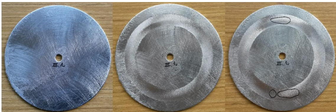
Obrázek 9: Lázeň s 1,12 hm. % Sn vzorek č. 1 (zleva) před testem, po 1600 cyklech, po 2600 cyklech s označenými místy bez zinkového povlaku
