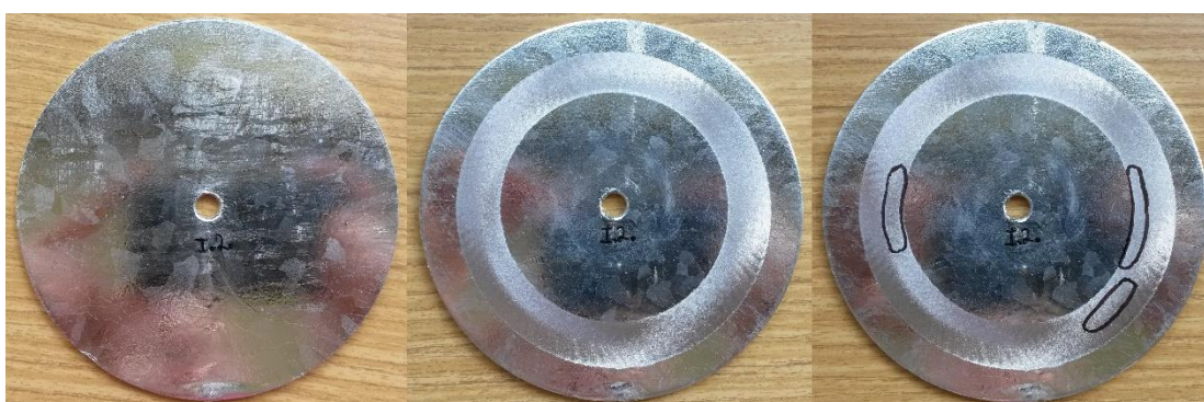
Obrázek 5: Lázeň s 0,068 hm. % Sn vzorek č. 2 (zleva) před testem, po 1600 cyklech, po 2800 cyklech s označenými místy bez zinkového povlaku
