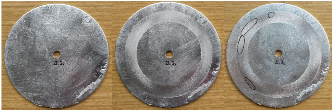
Obrázek 7: Lázeň s 0,499 hm. % Sn vzorek č. 3 (zleva) před testem, po 1600 cyklech, po 2800 cyklech s označenými místy bez zinkového povlaku
