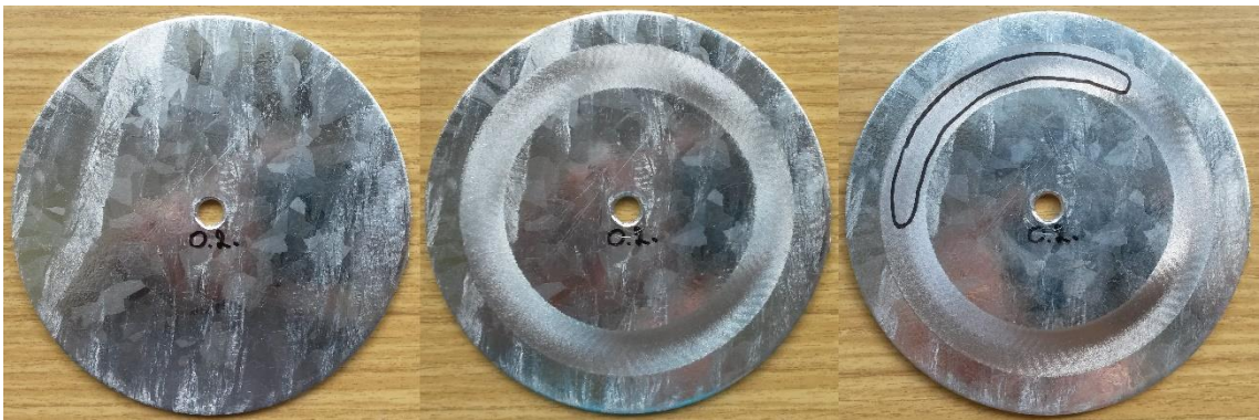
Obrázek 2: Lázeň s 0 hm. % Sn vzorek č. 2 (zleva) před testem, po 1600 cyklech, po 3000 cyklech s označenými místy bez zinkového povlaku
