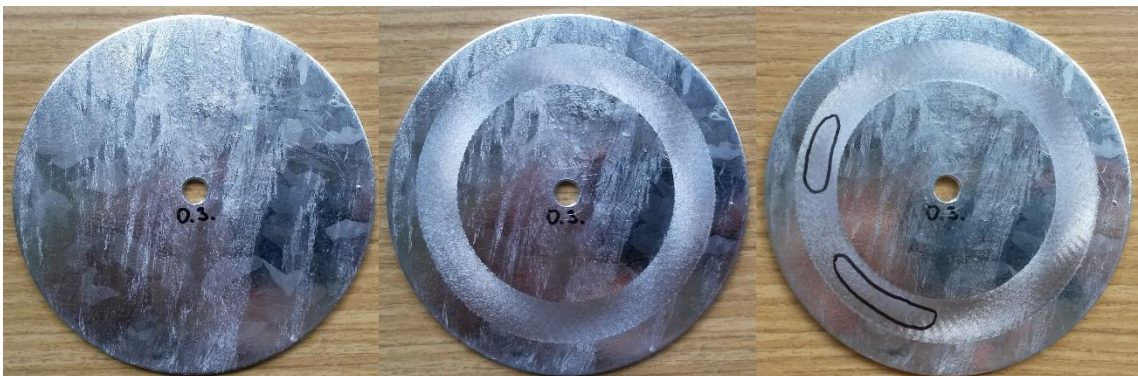
Obrázek 3: Lázeň s 0 hm. % Sn vzorek č. 3 (zleva) před testem, po 1600 cyklech, po 3000 cyklech s označenými místy bez zinkového povlaku
