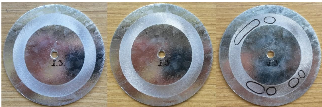
Obr. 29: Vzorek č. 3 z lázně s 0,068 hm. % Sn (zleva) po 1200 cyklech, 2000 cyklech, 2800 cyklech s označenými místy bez zinkového povlaku
