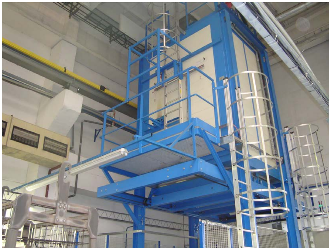
Obr.6.15: Elektrická vzduchová pec s ochlazením do vodní lázně
