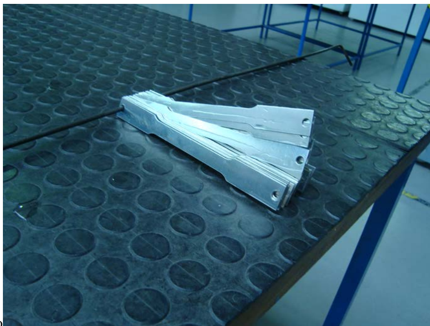
Obr.6.16: Část plechů po ochlazení ve vodní lázni
