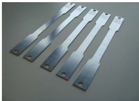
Obr.6.12: Vzorky před mechanickými zkouškami
