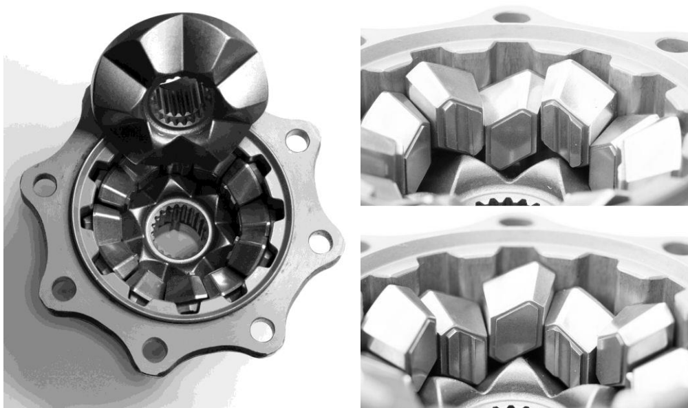
Obrázek 26 - Diferenciál s posuvnými kameny [21]
