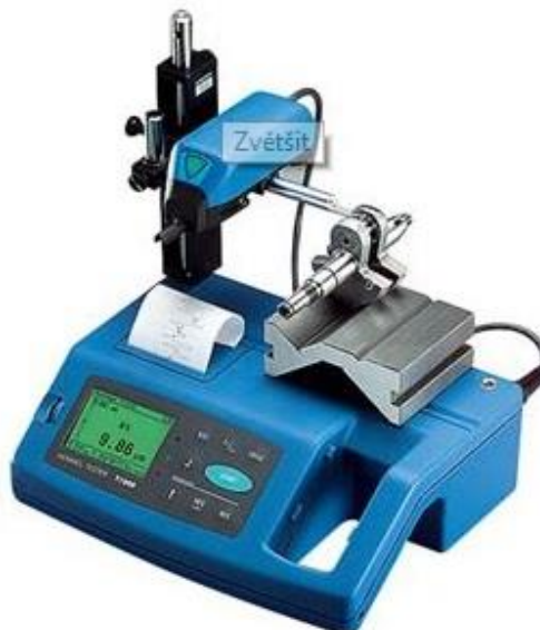
Obr. 13: Liniový profilometr HOMMEL TESTER T100 pro měření drsnosti
