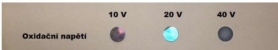
Obr. 16: Vzorky anodizované při různém napětí v H_3PO_4
