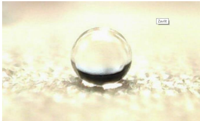
Obr. 10: Ukázka metody kontaktního úhlu na nesmáčivém povrchu
