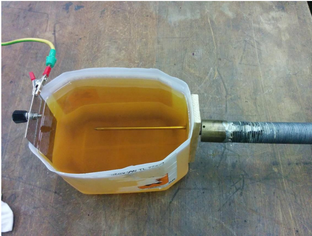
Obr. 27 Souprava s transformátorovým olejem.
