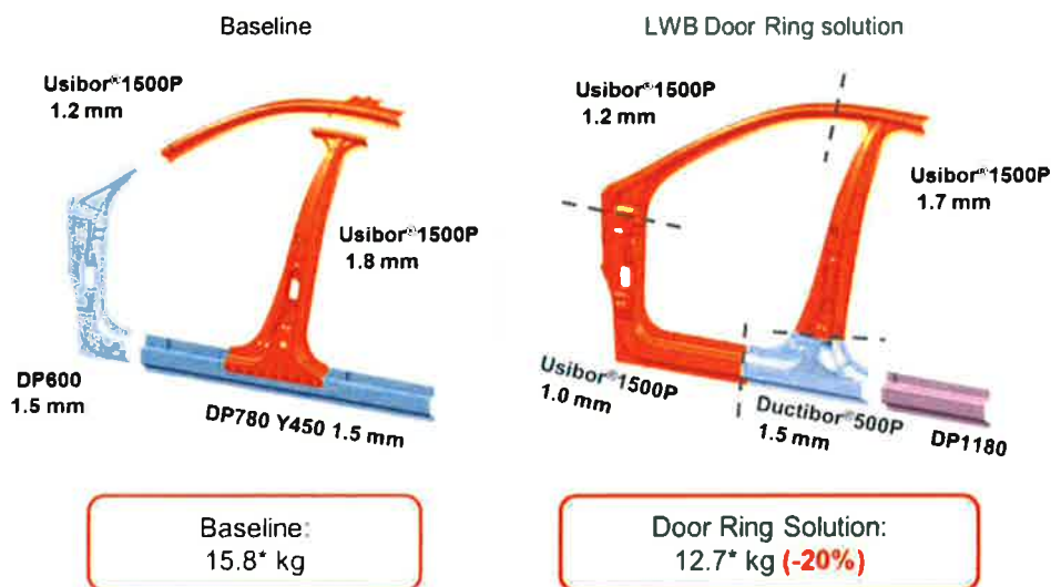
Obr. 1. Příklad nahrazení oceli DP600 ocelí USIBOR® 1500 [16]
