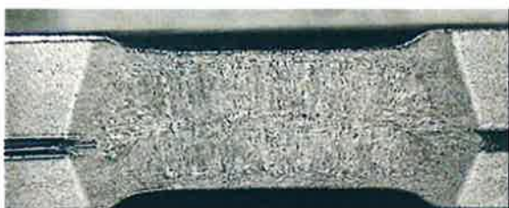
Obr. 28. Detail homogenního svarového spoje oceli USIBOR® 1500 [9]
