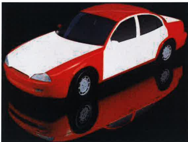
Obr. 11. Vnější prvky karoserie [7]
