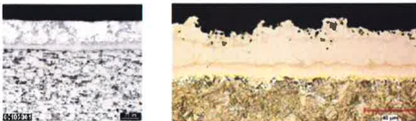
Obr. 19. Příčný řez součástí z oceli USIBOR® 1500-AS [9]
