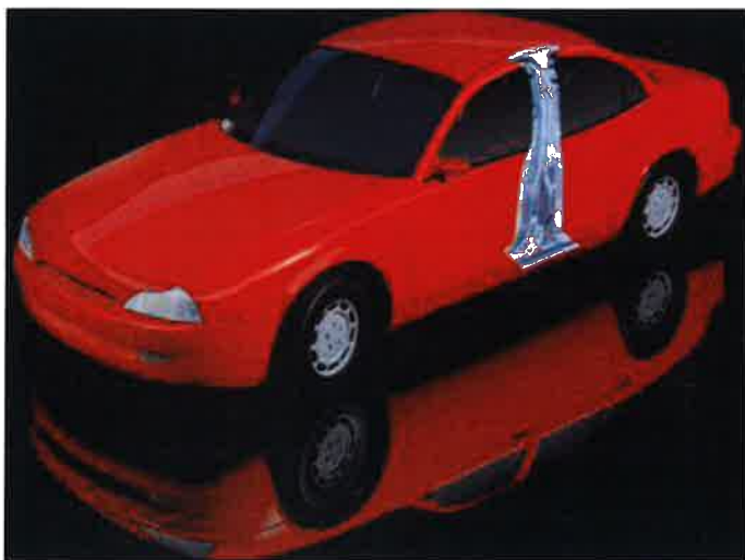
Obr. 9. Sloupek B v karoserii automobilu [7]
