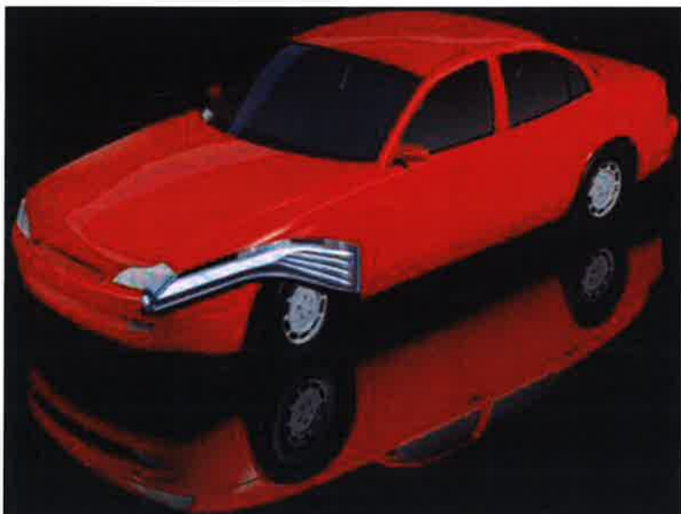
Obr. 8. Umístění předního příčníku na karoserii automobilu [7]
