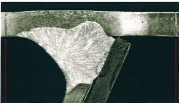
Obr. 30. Detail svarového spoje metodou MAG [9]
