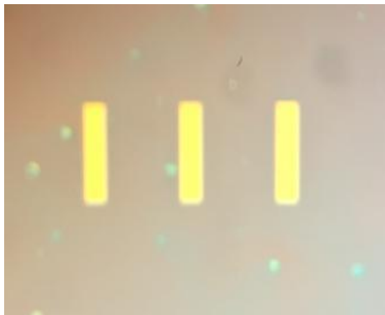
Obrázek 35: První expozice velkých ploch na Si+PMMA 0,9mm mezi pruhy (obrázek z optického mikroskopu)
