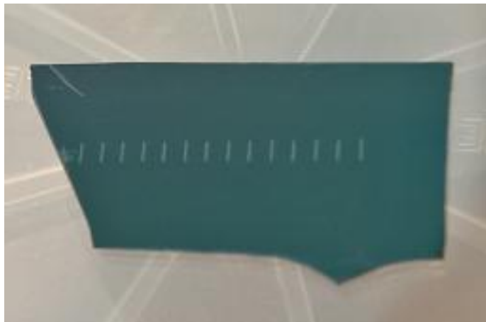
Obrázek 38: Vzorek se zjednodušenou grafikou pro růst v dávkovém reaktoru (obrázek z optického mikroskopu)
