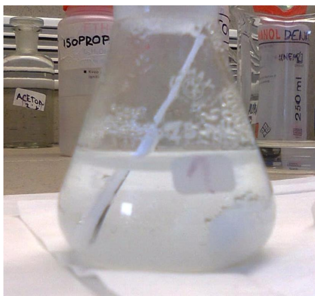
Obrázek 41: Dávkový reaktor používaný na UFE, uvnitř reaktoru je přípravek se substrátem
