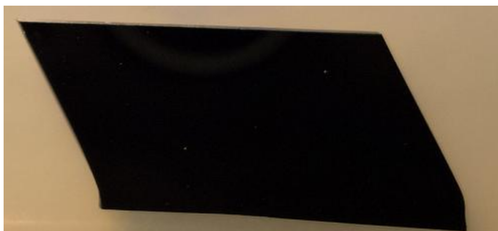
Obrázek 40: Ukázka nepravoúhlého lomu křemíku 111
