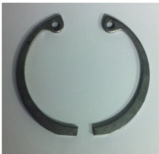
Obr. 35 Pojistný kroužek po zkoušce na PCN
