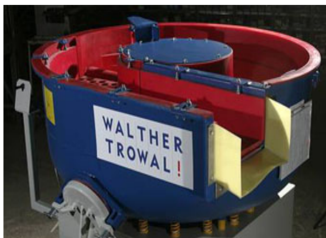
Obr. 5 Vibrační zařízení s kruhovou nádobou [17]
