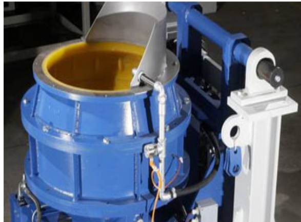
Obr.8 Odstředivá omílací zařízení[17]
