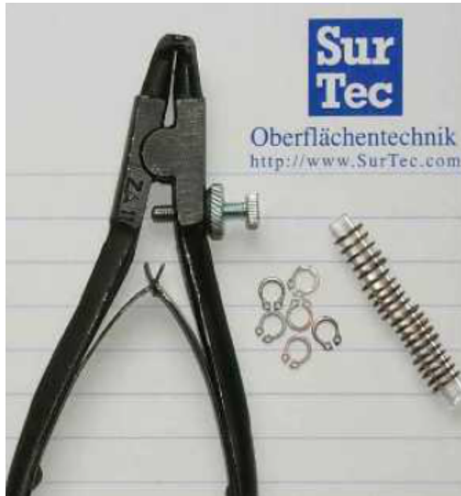
Obr. 28 Testovací sada firmy SurTech pro vodíkové křehnutí [11]
