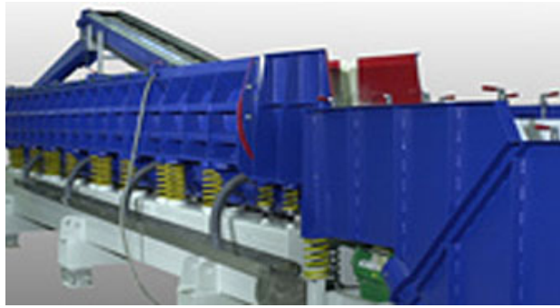
Obr. 7 Lineární průchozí omílací zařízení[17]
