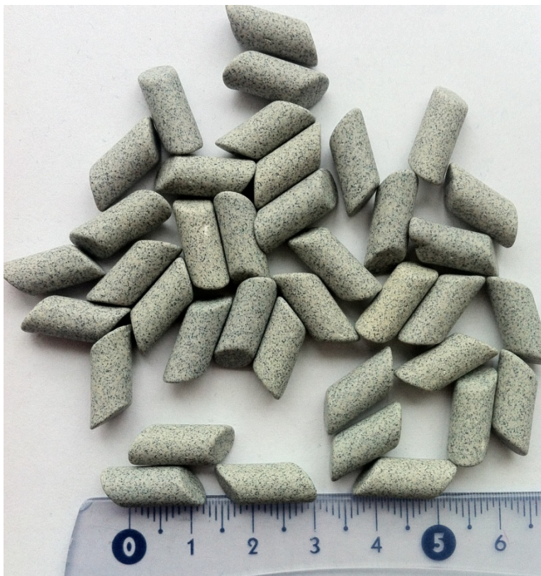
Obr. 30 Omílací tělíska 6 x 13 mm (Technoservis MT, s.r.o.)
