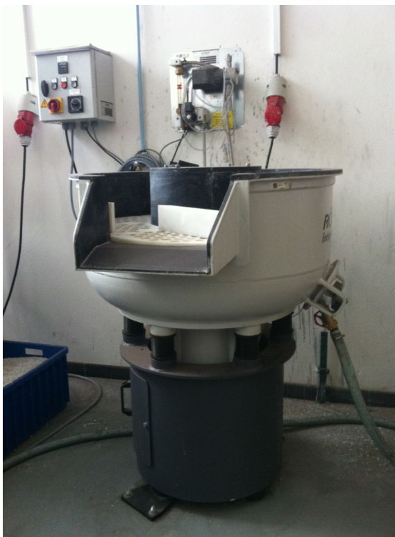
Obr. 29 Kruhové vibrační zařízení Rösler CER 125 (Ústav strojírenské technologie FS ČVUT v Praze)
