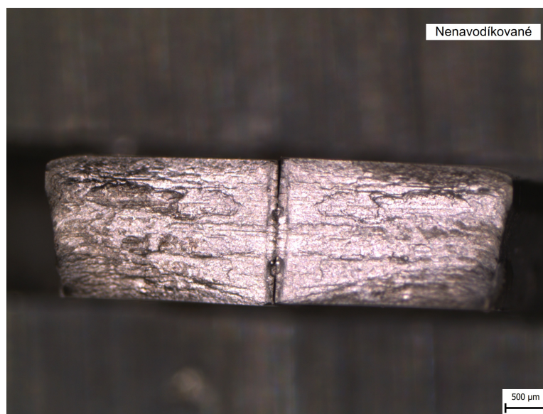
Obr. 37 Lom nenavodíkovaného vzorku
