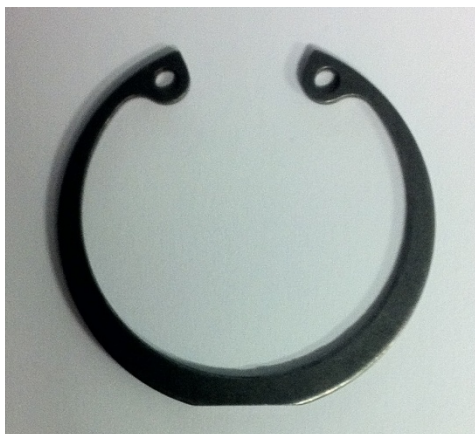
Obr. 31 Pojistný kroužek DIN 472 40 x 2
