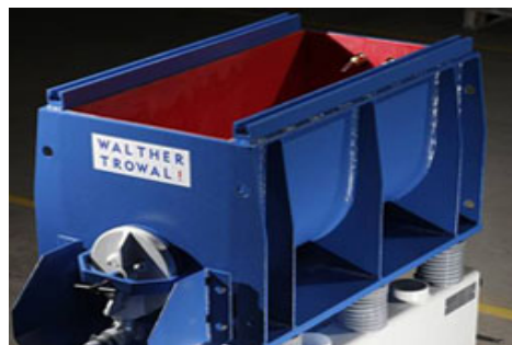
Obr. 6 Vibrační omílací žlab [17]
