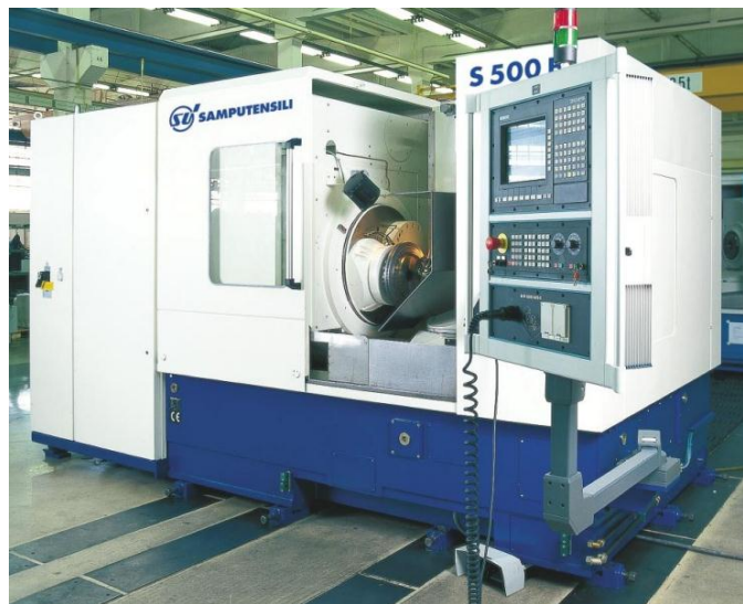
Obrázek 26: Obráběcí stroj na výrobu kuželových kol s hypoidním ozubením [6]
