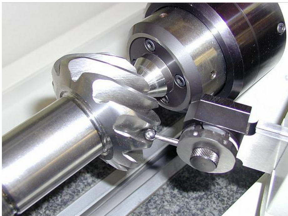
Obrázek 42: Měření radiálního házení [29]
