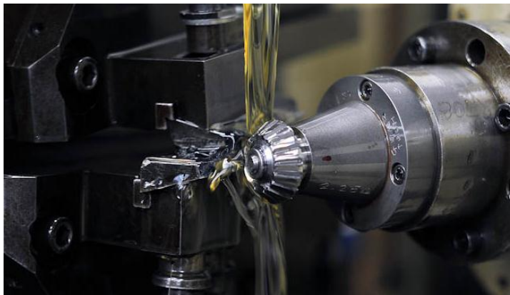
Obrázek 22: Obrázení ozubení kuželového kola dvěma noži [9]
