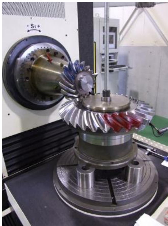
Obrázek 40: Kontrola jednobokým odvalem[25]
