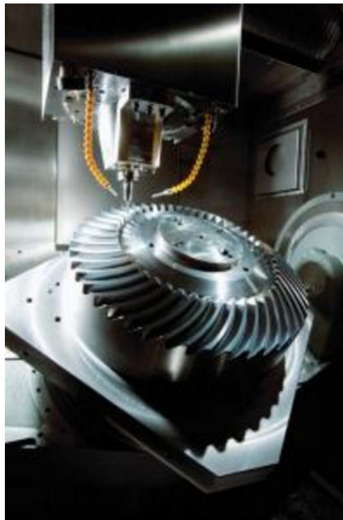
Obrázek 33: Pětiosé obrábění kuželového ozubeného kola [21]
