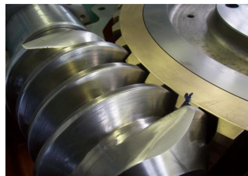
Obr. 1.4 Záběr bronzového věnce s ocelovým šnekem
