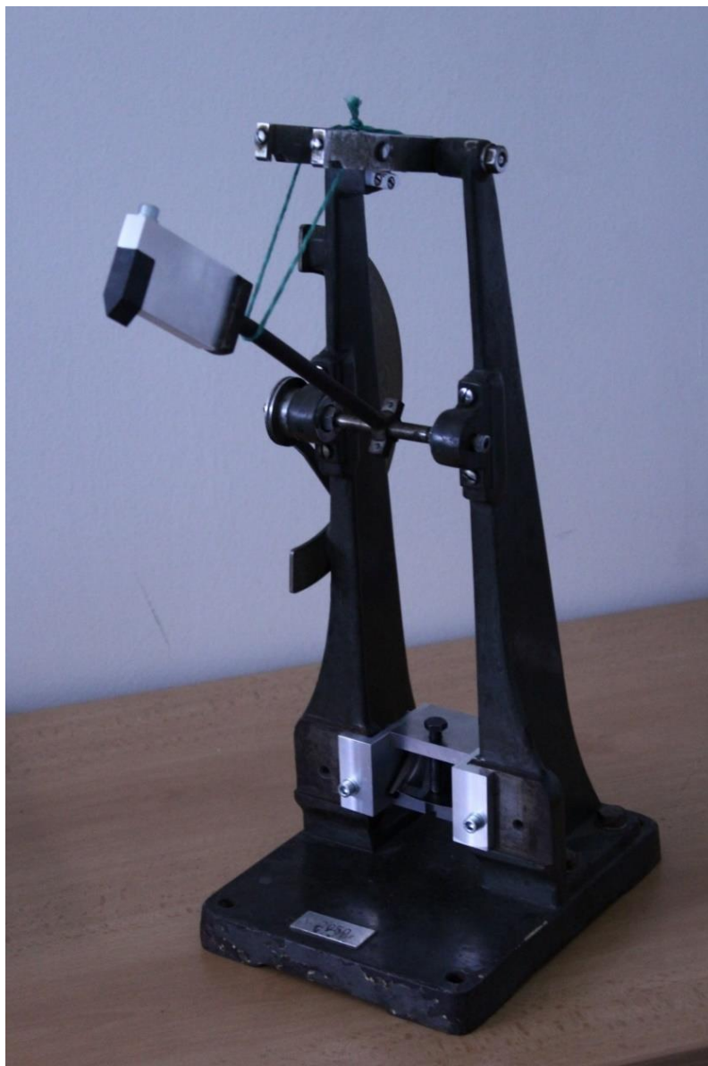
Obr. 14: Upravené Charpyho kladivo připravené na indentační zkoušku lopatky
