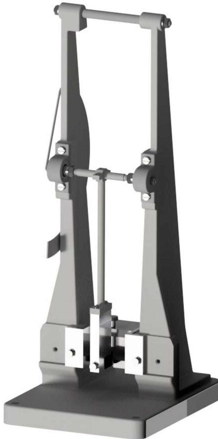
Obr. 13: 3D Model upraveného Charpyho kladiva (vyhlazený metodou sledování paprsku)
