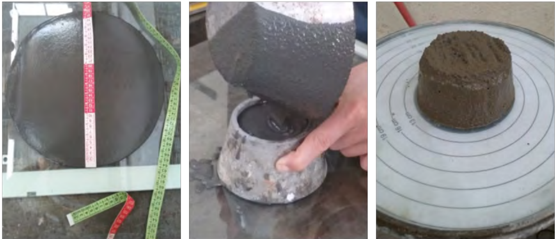
Fig. 14: Mini slump testing of HSM and PPCM
