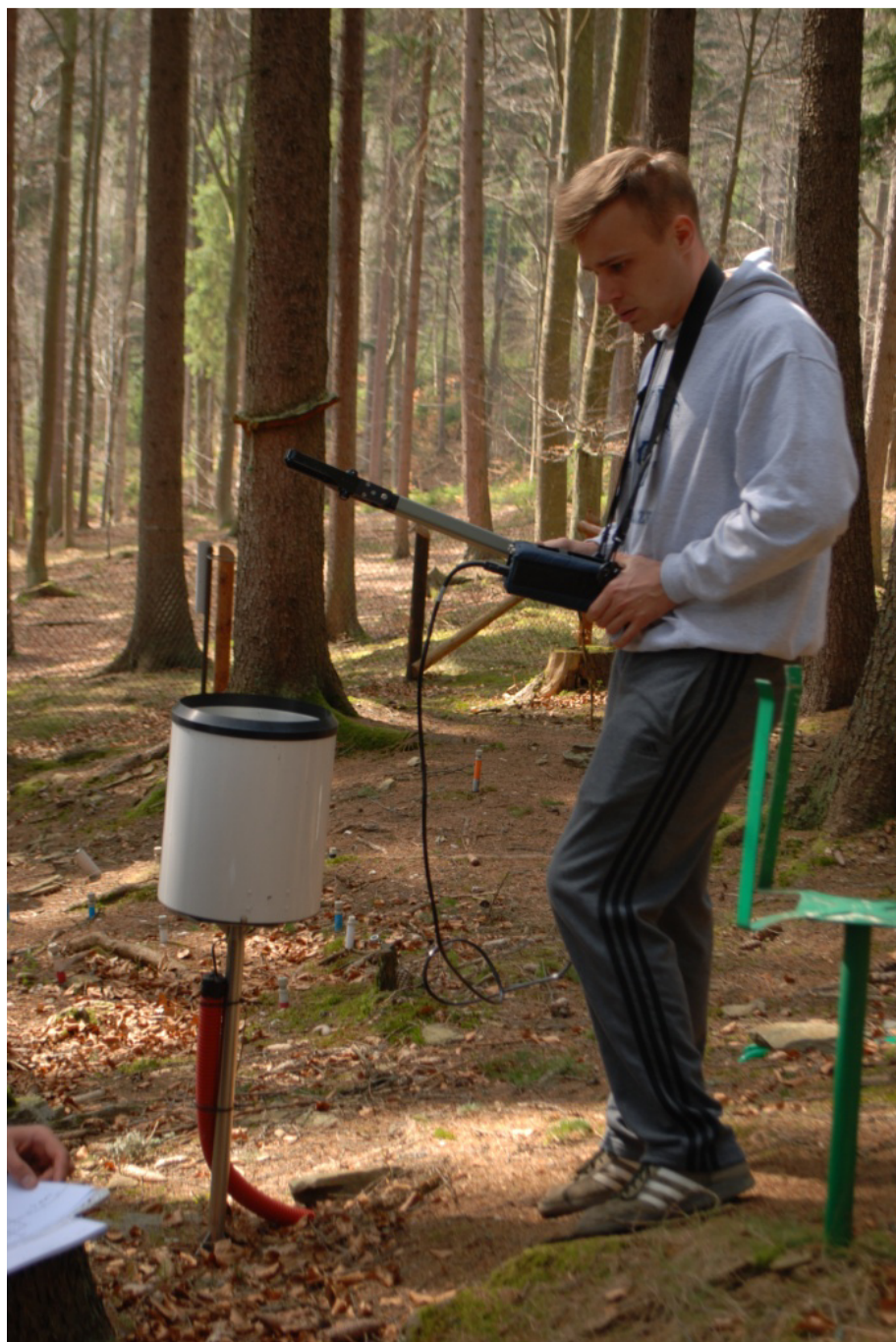
Obr. 20. Měření indexu listové plochy na experimentální oplocené ploše v rámci povodí Liz během jednorázové kampaně na jaře roku 2014 pomocí přístroje LAI 2000.
