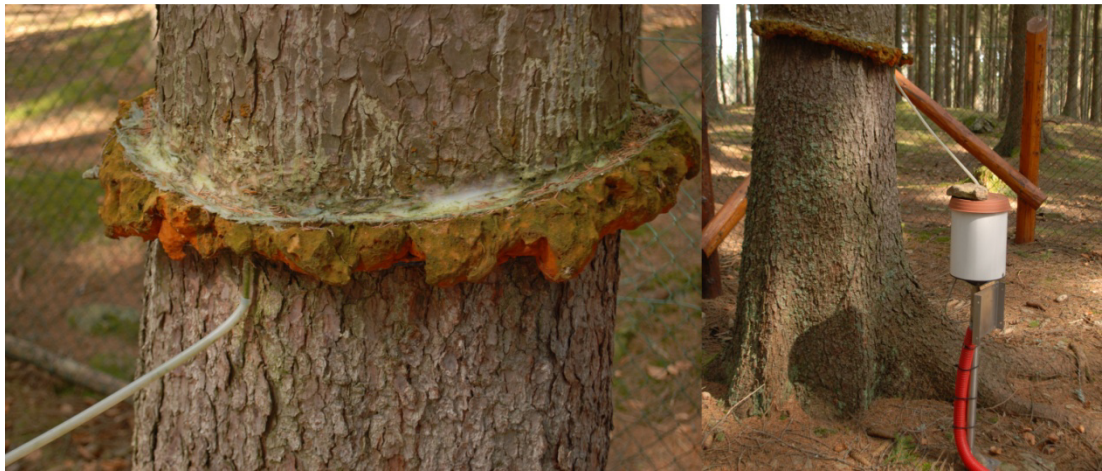
Obr. 19. Měření stoku po kmeni na experimentálním povodí Liz.
