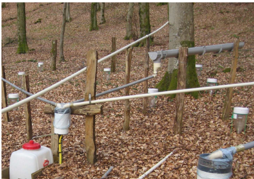
Obr. 12. Žlab určený k měření podkorunové srážky. Převzato z Gerrits (2010).
