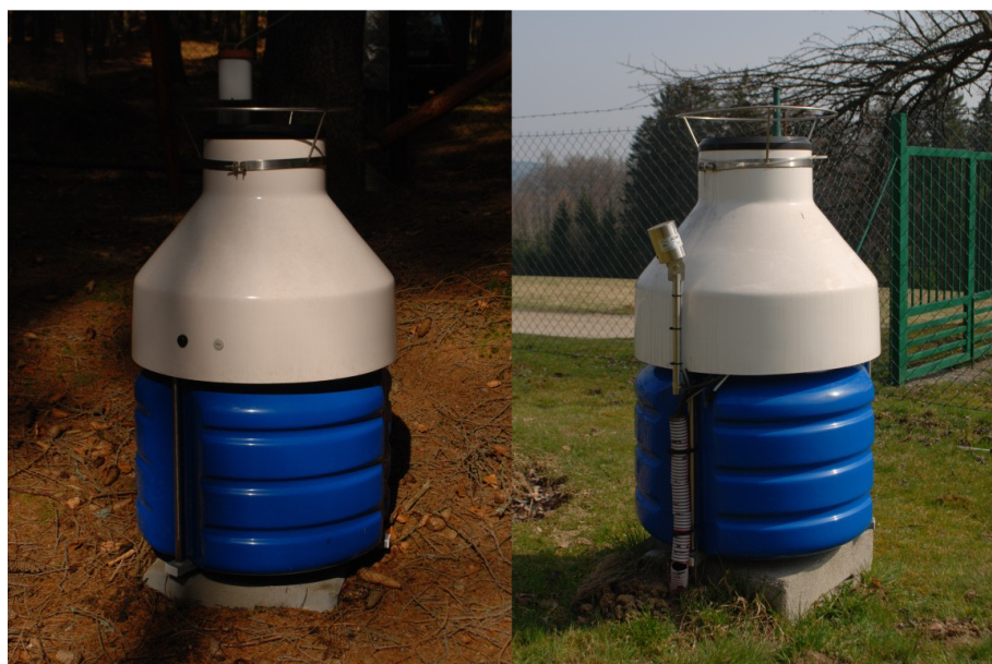
Obr. 29. Váhový srážkoměr WRG – SF na zalesněné experimentální ploše a váhový srážkoměr WRG – OA na horské louce.
