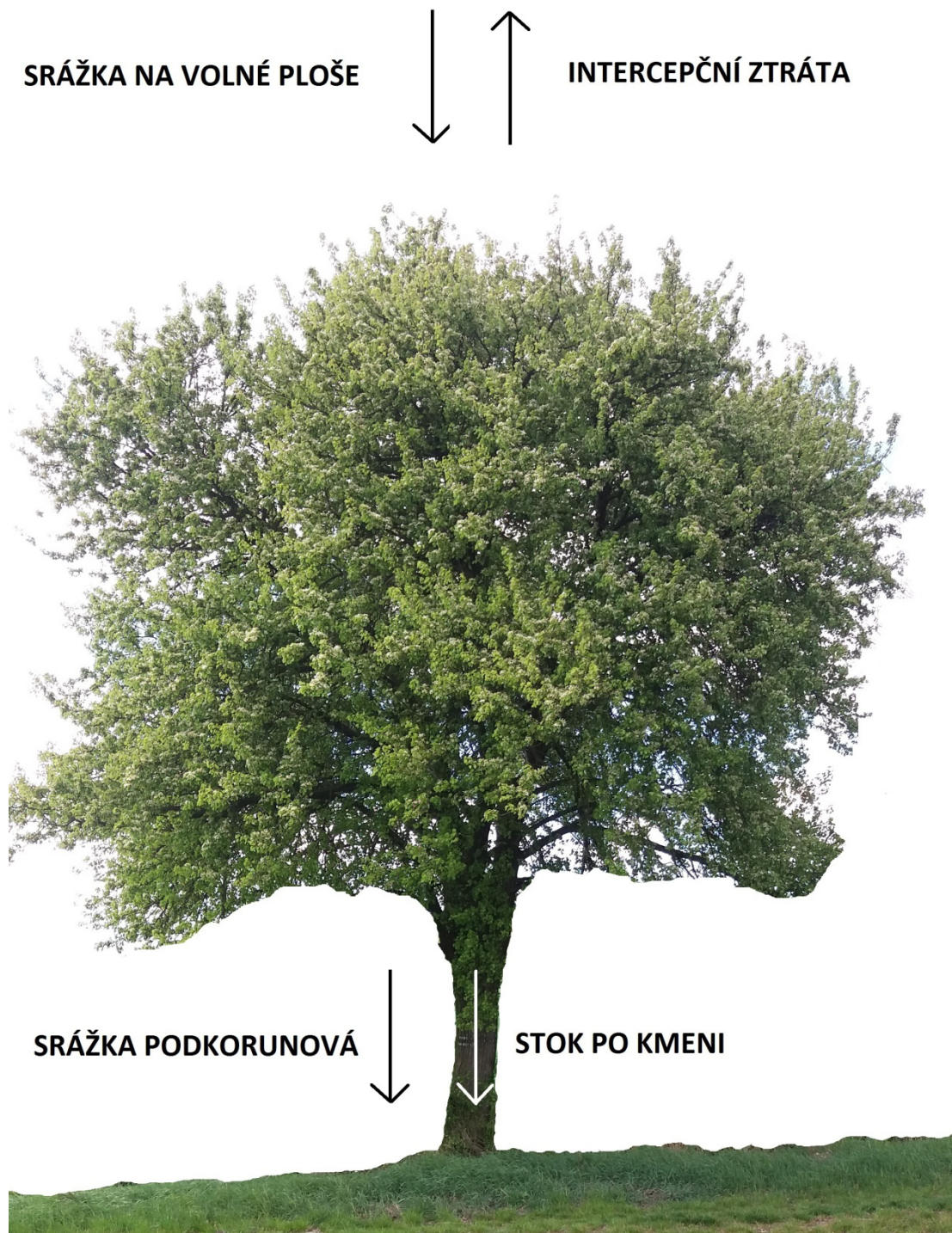
Obr. 1. Schematické zobrazení procesu intercepce.
