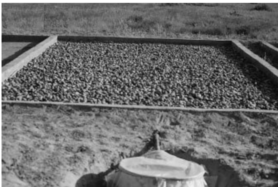
Obr. 17. Měření intercepční ztráty štěrku. Převzato z Li et al. (2000).
