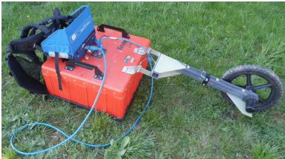
Obr. 10: SIR-3000 s 200 MHz anténou, řídicí jednotka se slunečním stínítkem; Zdroj: autor
