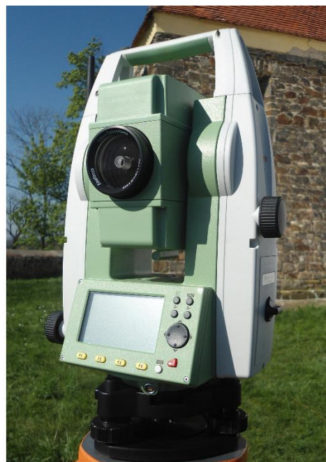
Obr. 24: Totální stanice Trimble 3603 DR (vlevo) a Leica TS02; Zdroj: autor
