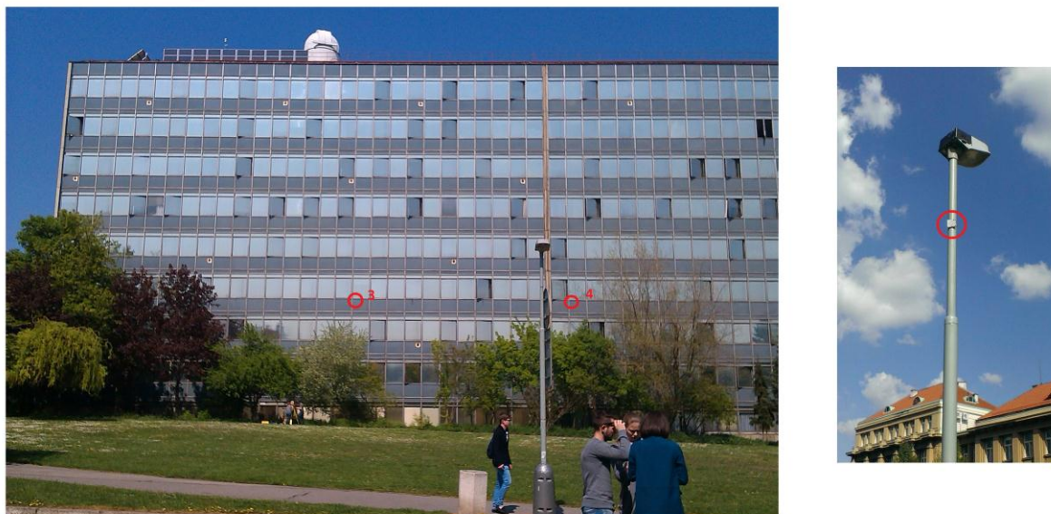
Obr. 2.2 Ukázka stabilizace bodů
