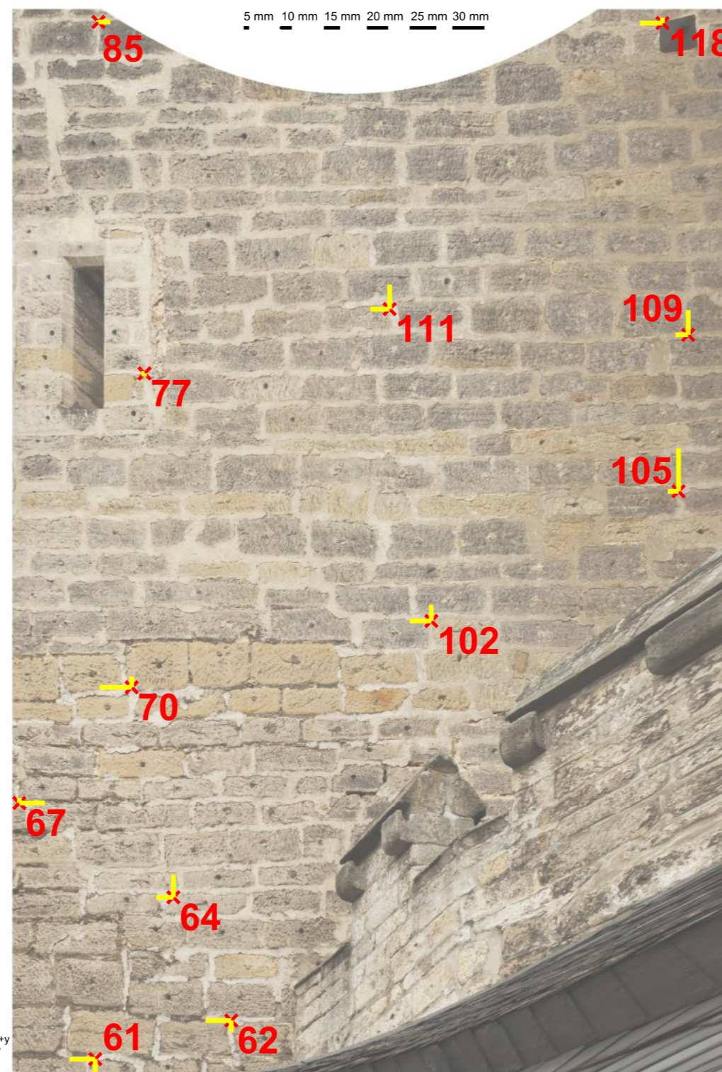
Obr.: Oříznutý rozvinutý snímek a souřadnicové odchylky na vřícovacích bodech
