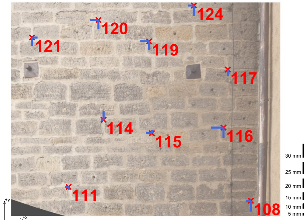
Obr.: Oříznutý rozvinutý snímek a souřadnicové odchylky na vřícovacích bodech
