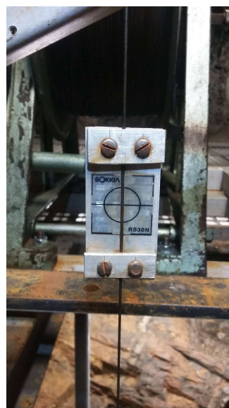
Obr. 5.1c: Speciální odrazný terčik [zdroj vlastní]
