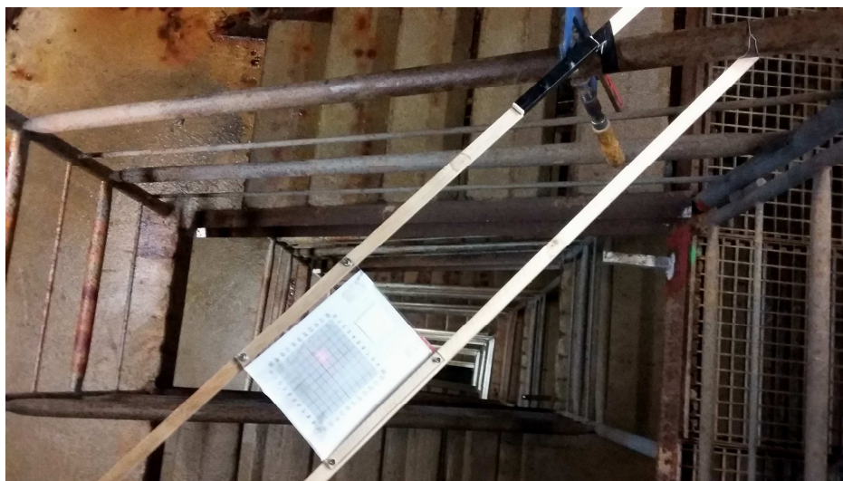
Obr. 5.7: Uchycení terče v horizontu 20 [zdroj vlastní]
