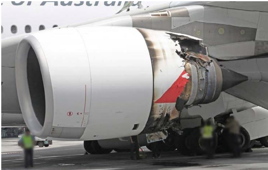
Obrázek č. 21: Airbus A380 po incidentu během letu QF32
