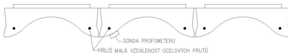
Obr. 2.62: Schéma měření Profometerem 3
