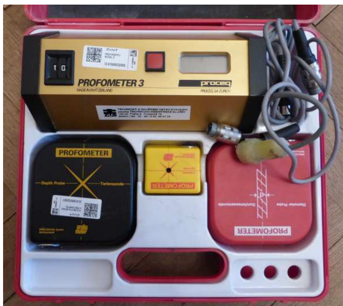
Obr. 2.61: Profometer 3 (Proceq) – zleva: vlastní konstrukce přístroje, hloubková sonda, základní sonda, průměrová sonda
