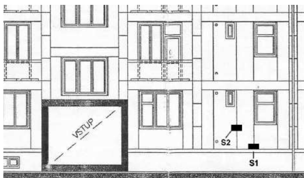
Obr. 2.26: Znárodnění polohy provedených sond na severním průčelí (18)
