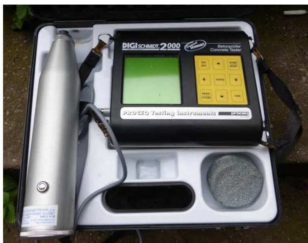
Obr. 2.55: Přístroj Digi-Schmidt 2000 od firmy Proceq
