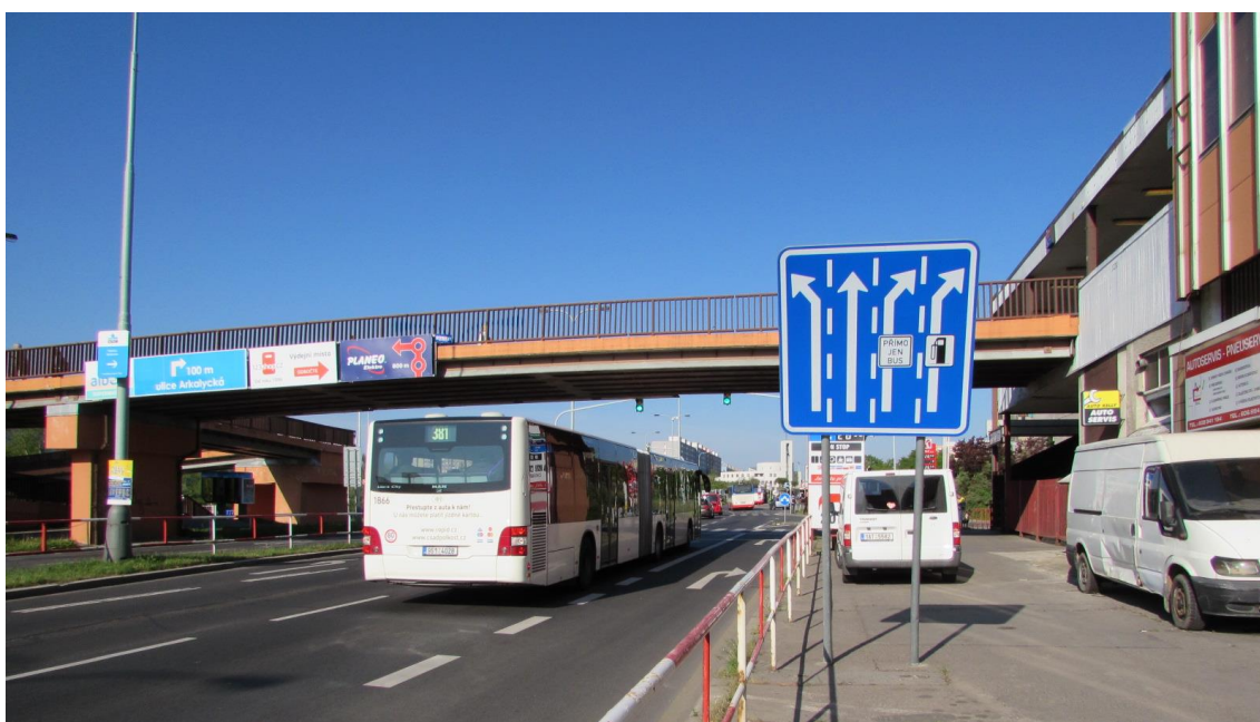
Obrázek 39 - značení výlučného směru v řadících pruzích (Háje), za křižovatkou navazuje v pravém pruhu vyhrazený jízdny pruh pro autobusy
