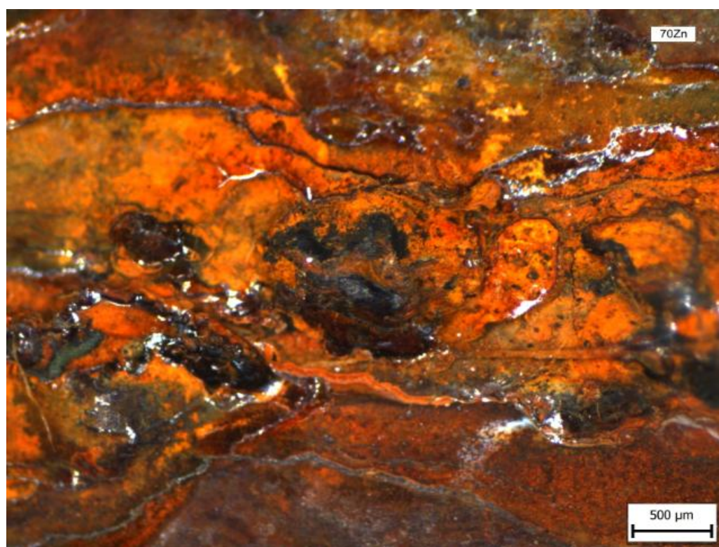
Obrázek 72: Vzorek 70Zn - Detail korozních produktů v řezu po expozici 715 hod
