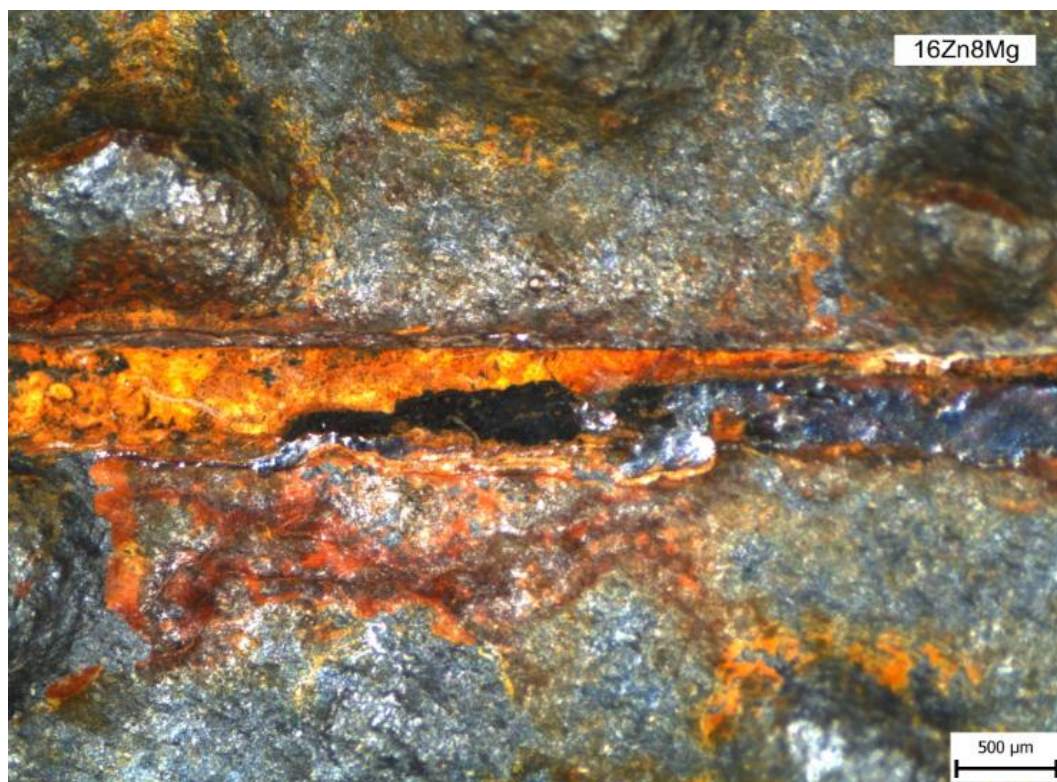
Obrázek 69: Vzorek 16Zn8Mg - Detail korozních produktů v řezu po expozici 1000 hod
