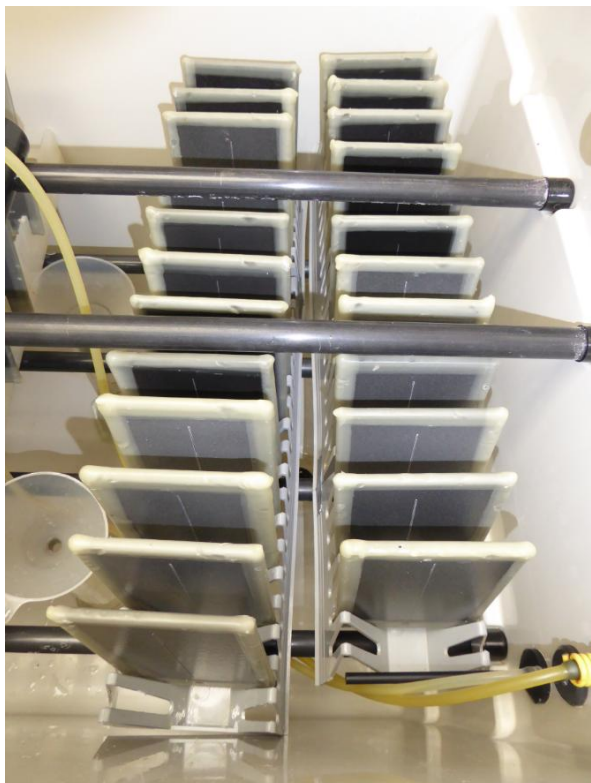
Obrázek 15: Expozice vzorků v komoře Liebisch S 400 M-TR
