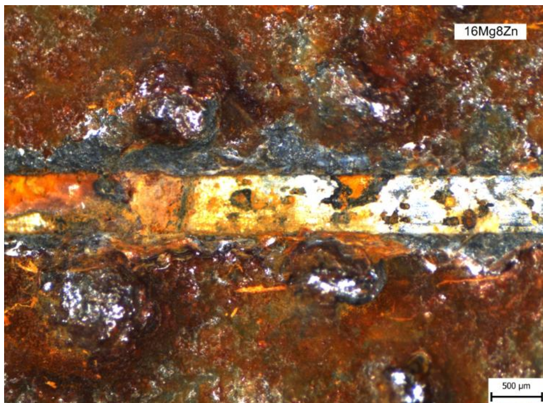
Obrázek 67: Vzorek 16Mg8Zn - Detail korozních produktů v řezu po expozici 1000 hod
