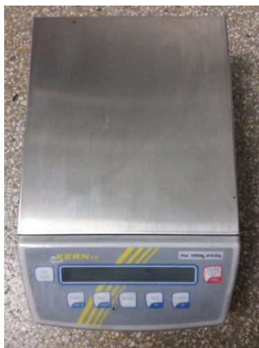
Obrázek 10: Laboratorní váhy KERN KB 10K0.05N
