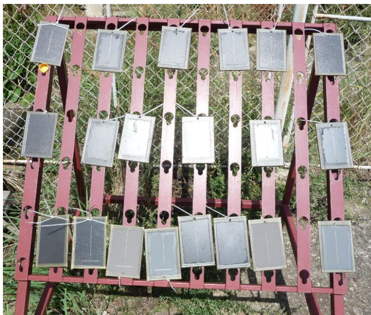
Obrázek 51: Vzorky exponované v atmosférických podmínkách
