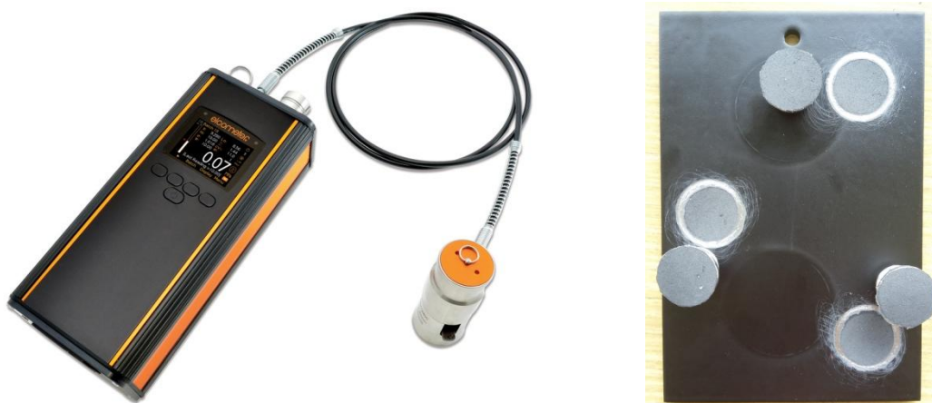
Obrázek 53: Zařízení Elcometer 510 (vlevo) [60], ukázka provedených odtrhů (vpravo)
