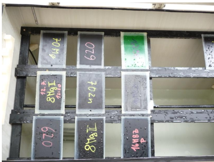
Obrázek 45: Expozice vzorků v prostředí kondenzace vody
