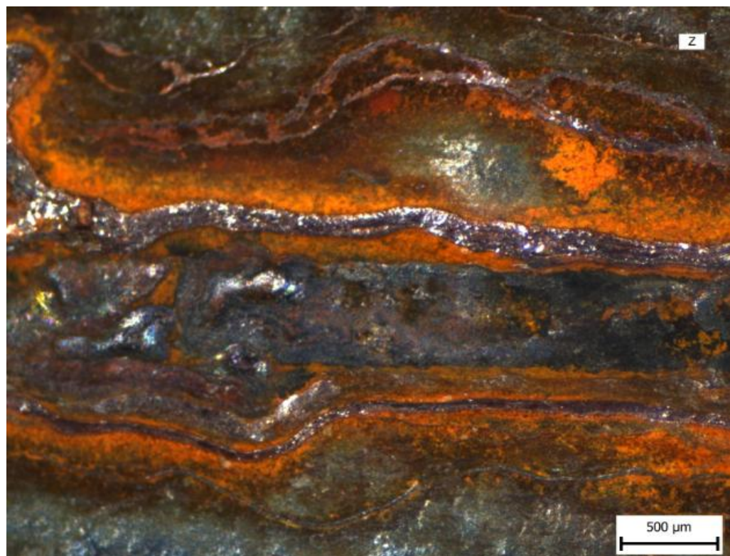
Obrázek 71: Vzorek Z - Detail korozních produktů v řezu po expozici 715 hod
