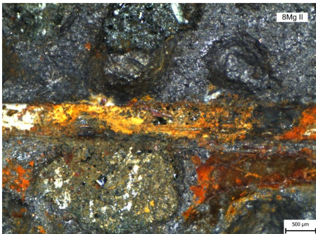
Obrázek 65: Vzorek 8Mg II - Detail korozních produktů v řezu po expozici 1000 hod
