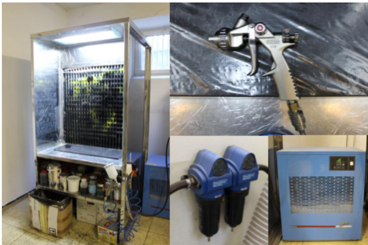
Obrázek 13: Lakovací box (vlevo), stříkací pistole EST+ 116 (vpravo nahoře), dvoustupňový filtr Donaldsen (uprostřed), vymrazovací box MTA Dry Energy DE103 (vpravo dole) [55]
