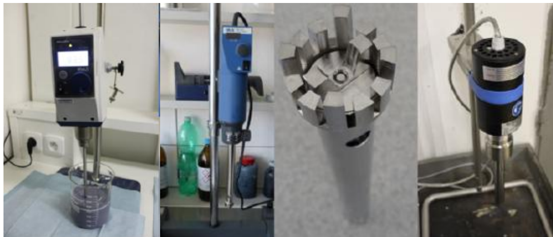
Obrázek 11: Lopátkové míchadlo WiseStirr HS-D (vlevo), míchadlo rotor - stator (uprostřed), ultrazvukový homogenizátor (vpravo) [55]
