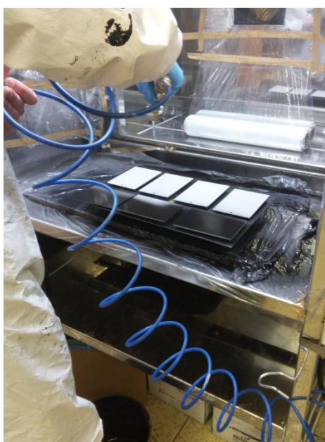
Obrázek 12: Ukázka aplikování nátěrové hmoty na vzorky pomocí HVLP
