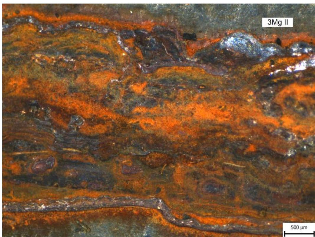
Obrázek 61: Vzorek 3Mg II - Detail korozních produktů v řezu po expozici 1000 hod
