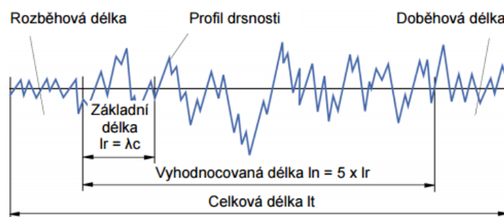
Obrázek 28: Základní a vyhodnocovaná délka, délka rozběhu a doběhu [32]
