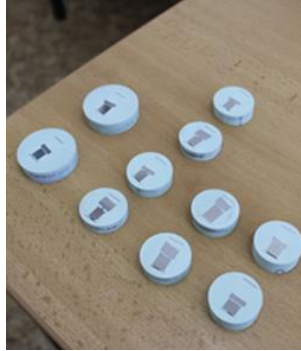
Obrázek 71: Vybroušené metalografické vzorky zalité za studena
