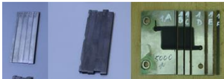
Obrázek 49: Nařezané destičky pro měření zbytkových napětí zleva frézované destičky, destičky po SP a destičky po LSP
