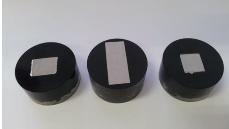
Obrázek 67: Vzorek zalisovány a zalitý za tepla po broušení
