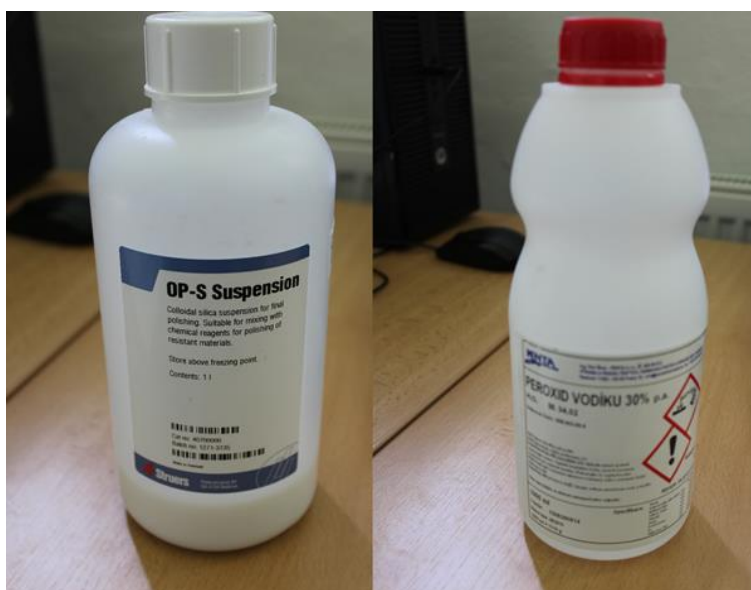
Obrázek 74: Přípravky použité pro konečnou operaci broušení (OP-S Suspension a Peroxid vodíku 30% p.a.)
