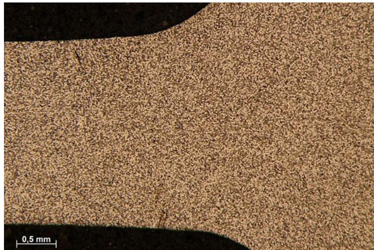
Obrázek 88: Makrostruktura v oblasti vetknutí lopatky – Kroll, 25x
