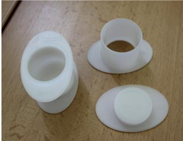
Obrázek 69: Formy pro výrobu metalografických vzorků za studena
