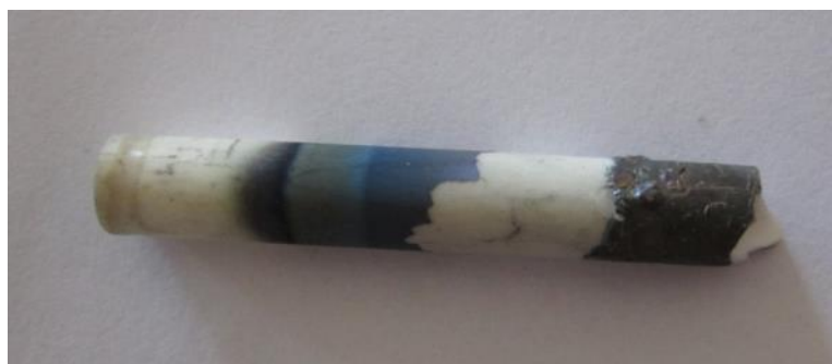
Obrázek 29: poškozená ochranná trubice Luxal
