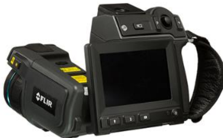
Obrázek 30: termokamera FLIR T640 [30]
