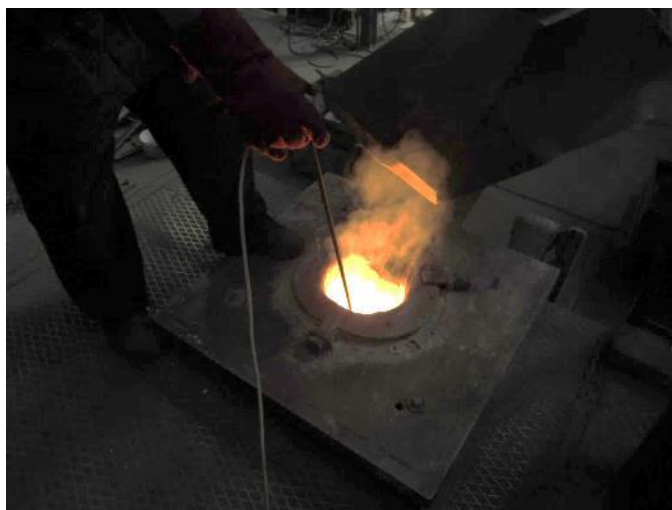
Obrázek 15: měření taveniny v indukční peci
