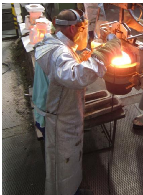
Obrázek 16: měření teploty taveniny v licí pánvi
