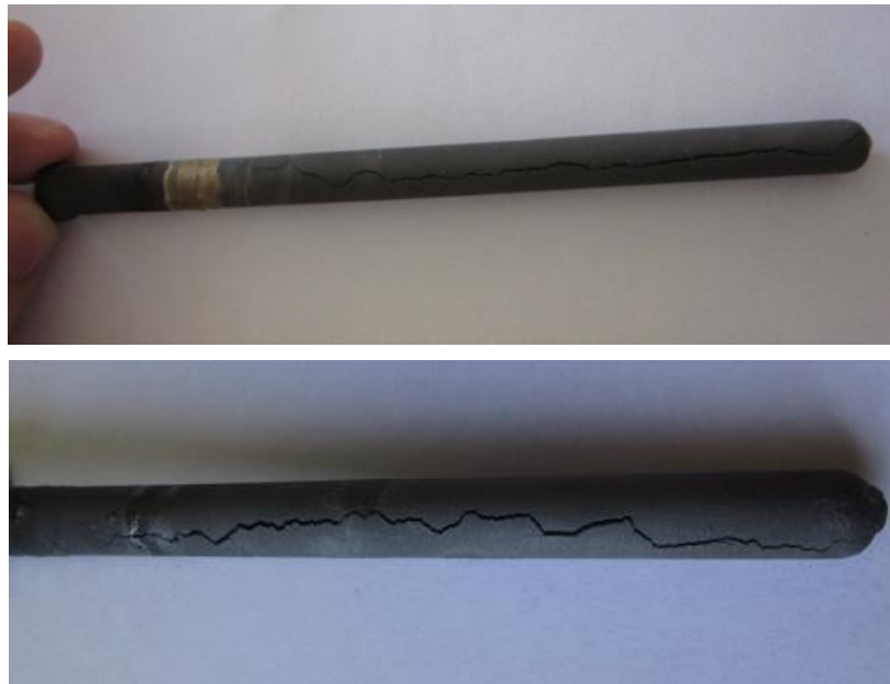
Obrázek 27: poškozené ochranné trubice vlivem ponoru do taveniny
