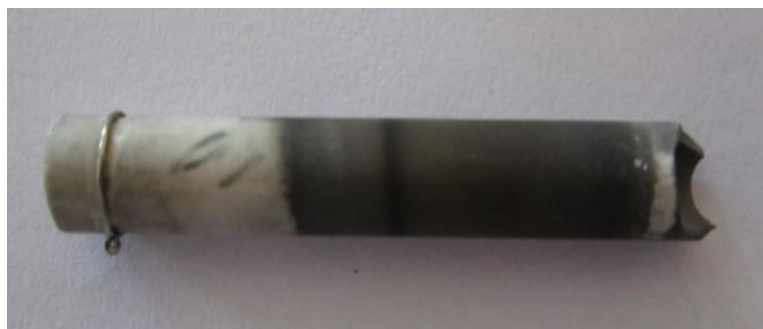
Obrázek 28: poškozená ochranná trubice Lunit
