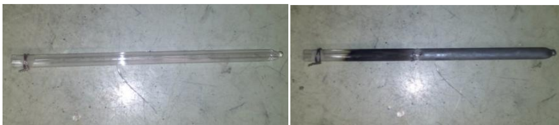
Obrázek 22: ochranná trubice z křemenného skla
