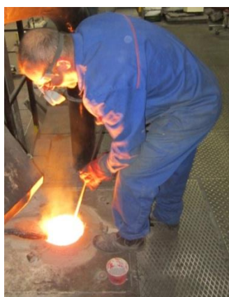
Obr. 48, Obr. 49, Obr. 50: Postup vybírání strusky z povrchu taveniny (čištění taveniny)
