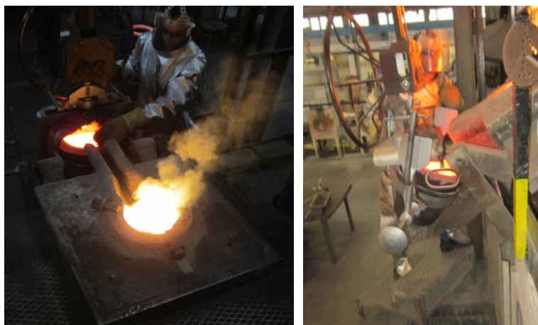
Obr. 54, Obr. 55: Přelévání taveniny z pece do pánve
