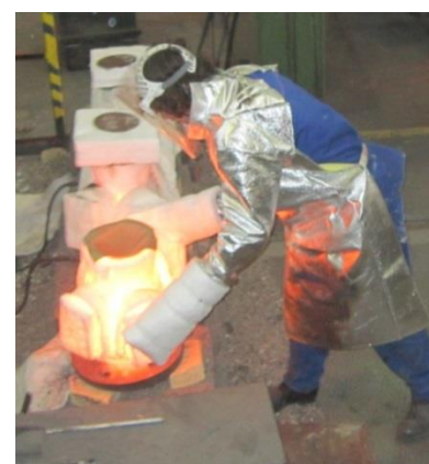
Obr. 51, Obr. 52, Obr. 53: Měření teploty v peci, vytažení skořepiny z předehřívací plynové pece a ustavení na přípravek
