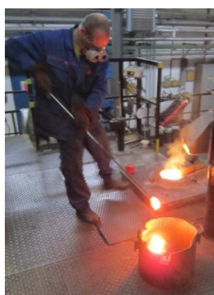
Obr. 48, Obr. 49, Obr. 50: Postup vybírání strusky z povrchu taveniny (čištění taveniny)
