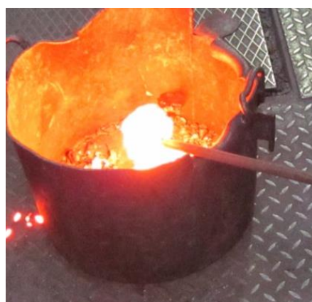
Obr. 48, Obr. 49, Obr. 50: Postup vybírání strusky z povrchu taveniny (čištění taveniny)
