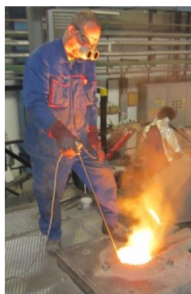
Obr. 51, Obr. 52, Obr. 53: Měření teploty v peci, vytažení skořepiny z předehřívací plynové pece a ustavení na přípravek
