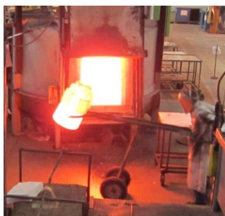
Obr. 51, Obr. 52, Obr. 53: Měření teploty v peci, vytažení skořepiny z předehřívací plynové pece a ustavení na přípravek
