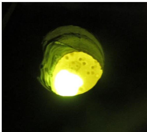
Obr. 47: Tavenina po odstranění strusky
