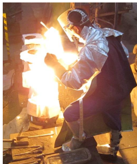
Obr. 57: Odlévání do předehřáté formy
