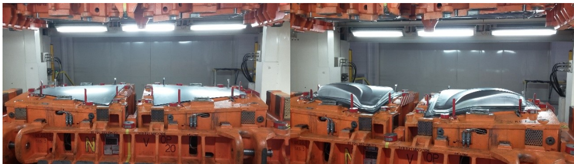
Obrázek 9-3, díl_2, nástřih před lisováním
