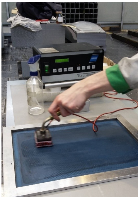
Obrázek 9-1, díl_1, aplikace deformační sítě
