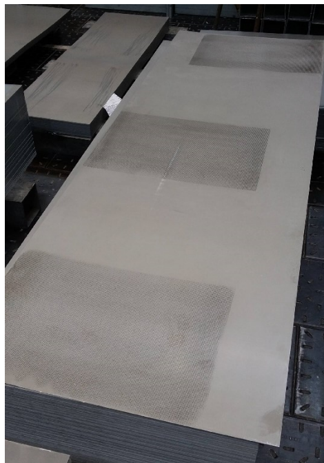
Obrázek 9-2, díl_1, nanesené deformační sítě
