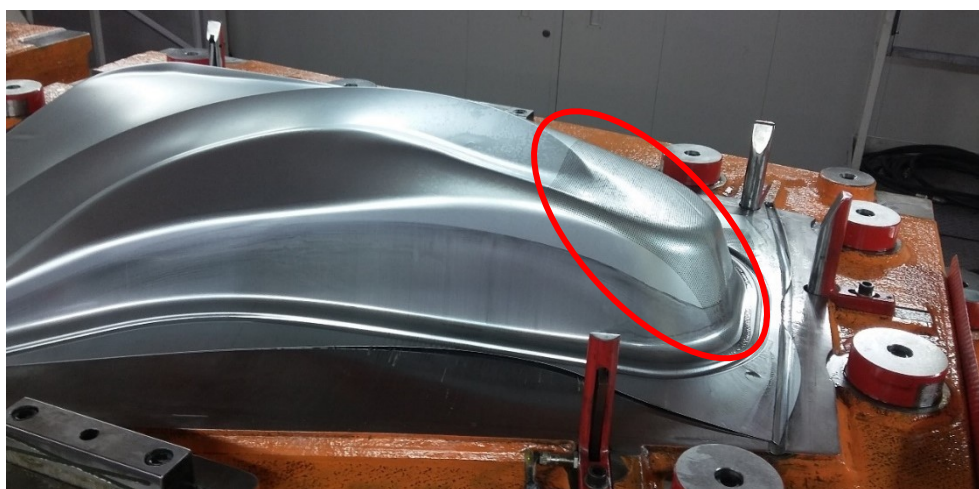
Obrázek 9-5, díl_2, vylisovaný díl s nanesenou deformační sítí
