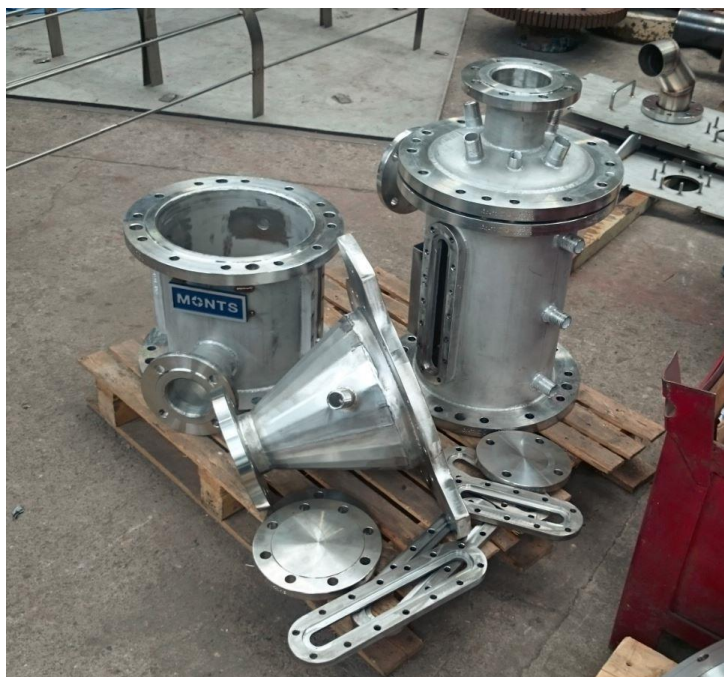
Obr. 34. Vyrobený separátor v priestoroch firmy Monts
