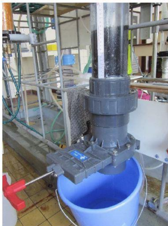
Obr. 4. Provádění experimentu - stanovení propustnosti vrstvy částic [16]
