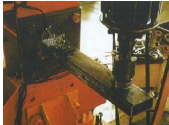
Obr. 13 Ohybový únavový test [4]
