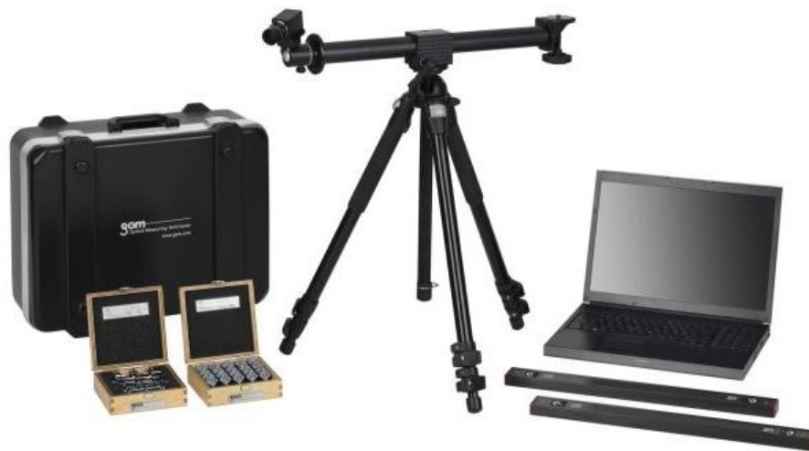
Obr. 29 Systém ARGUS a jeho příslušenství [15]
