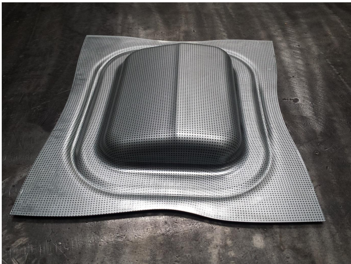
Obr. 63 Vylisek z materiálu HX 180 BD s nanesenou sítí
