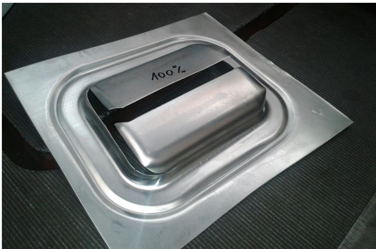
Obr. 64 Vylisek z materiálu AlMg 3 (100% dojezdu nástroje)
