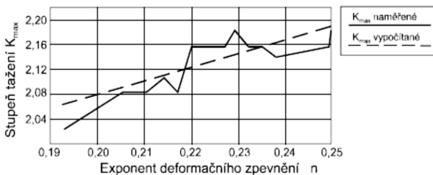
Obr. 22 Vliv exponentu zpevnění n_m na tažný poměr K [14]
