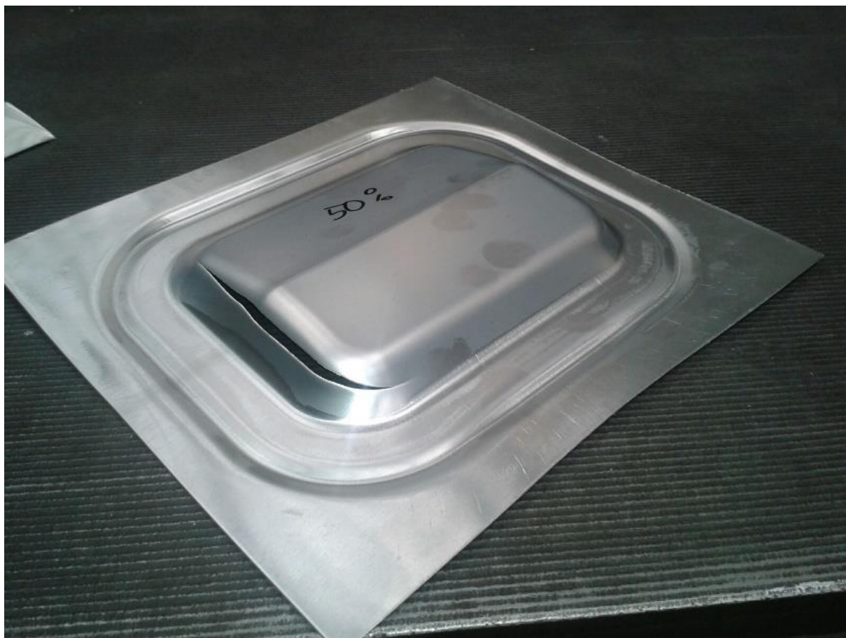
Obr. 65 Výlisek z materiálu AlMg 3 (50% dojezdu nástroje)
