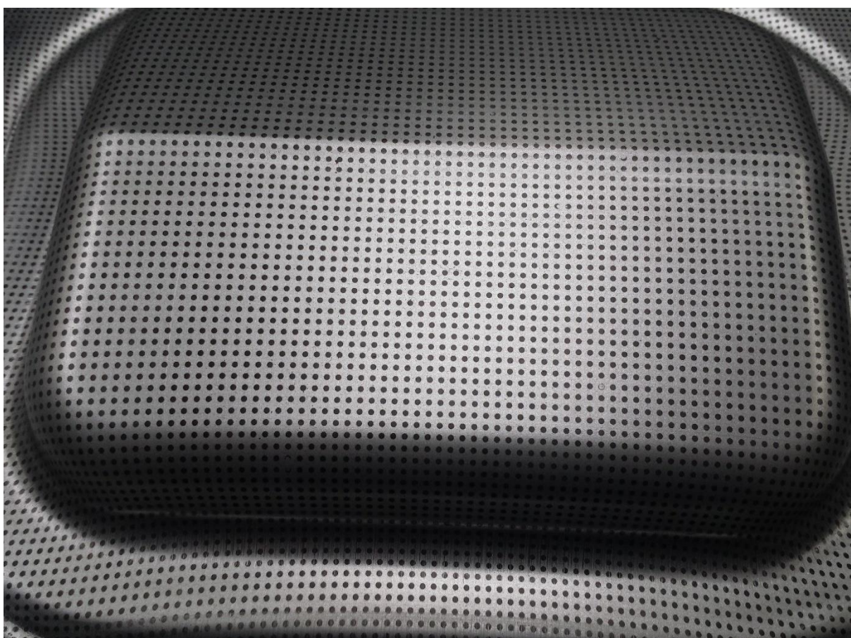
Obr. 62 Detail nanesené sítě na výlisku z materiálu HX 180 BD
